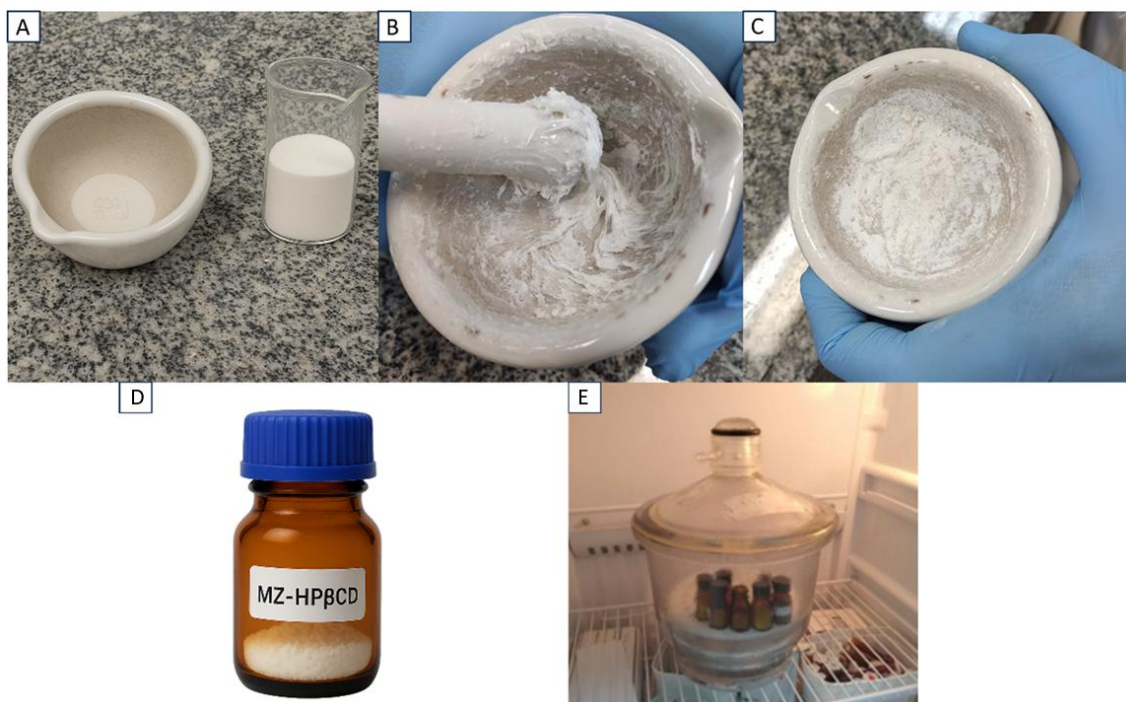
Figura 2.10. Obtenção do complexo de inclusão por maceração. Adição do herbicida à CD (A), mistura sob pressão e adição de solvente (B), mistura até a formação do composto seco (C), armazenamento apropriado (D) e dessecação sob vácuo (E). Fonte: O próprio autor (2025).
