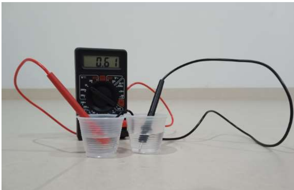
Figura 15: Energia gerada em cada célula voltaica
