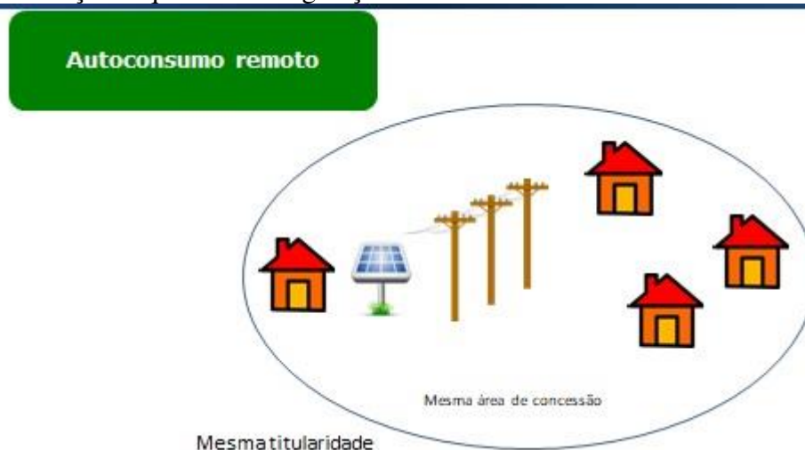
Figura 2 – Ilustração esquemática da geração distribuída da modalidade autoconsumo remoto
