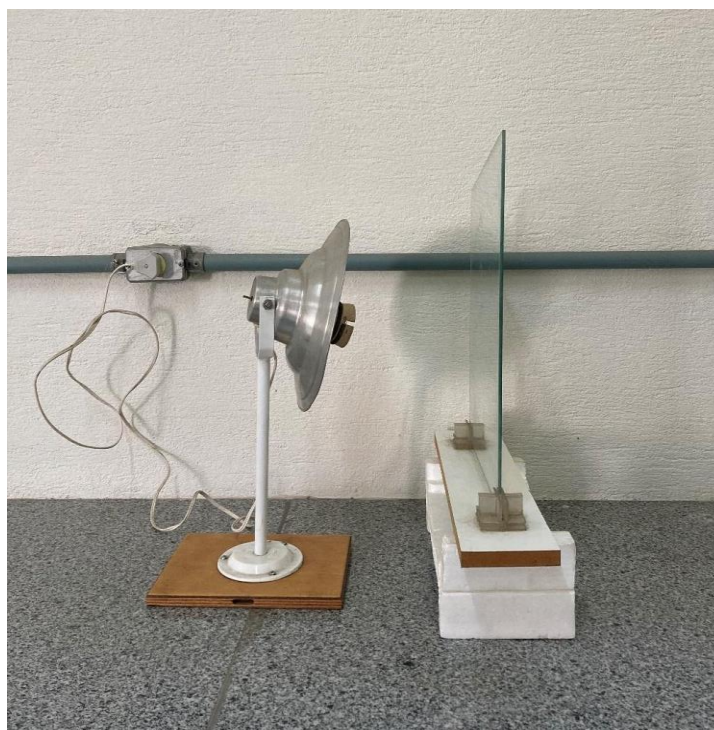
Figura 3 - Experimento utiliza uma resistência térmica para demonstrar a capacidade de absorção de calor do vidro
