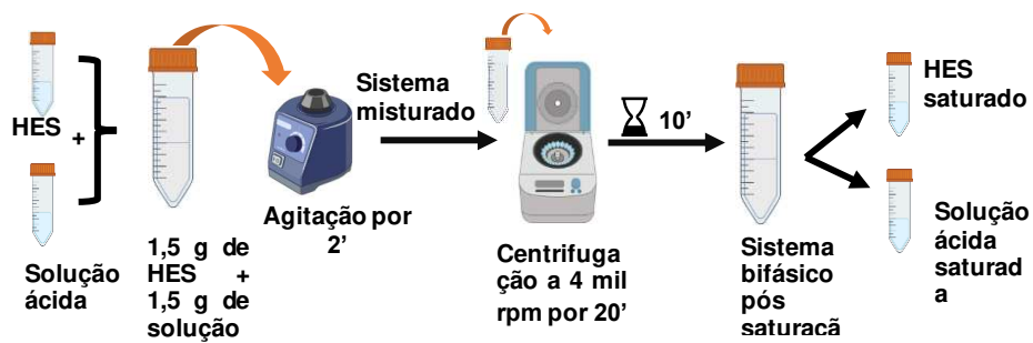
Figura 1. Esquema das etapas envolvidas para a saturação do HES.
