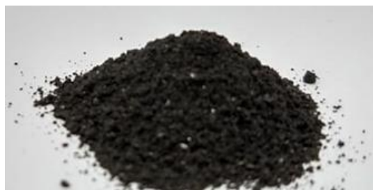
Figura 12. Pó do magneto obtido depois das etapas de desmontelamento, desmagnetização e moagem.
