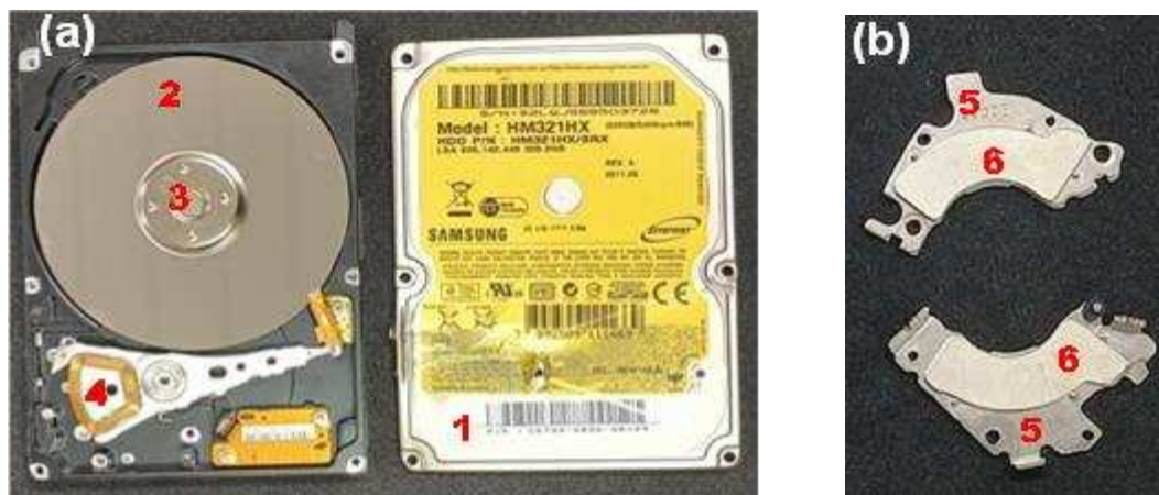
Figura 10. (a) Fotografia de um HDD manualmente desmontado. (b) Par de ímãs de NdFeB junto com sua capa metálica.
