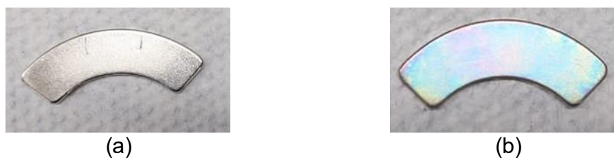
Figura 11. Fotografia de um dos ímãs (a) antes da desmagnetização e (b) depois da desmagnetização.
