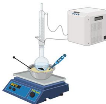
Figura 2. Aparato para a dissolução do pó do magneto.
