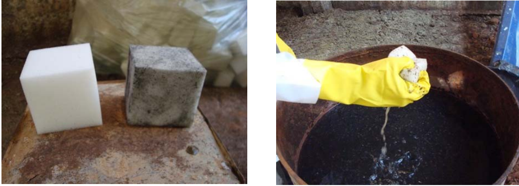
Figura 4.9: Espuma não inoculada x espuma inoculada; procedimento de inoculação.
