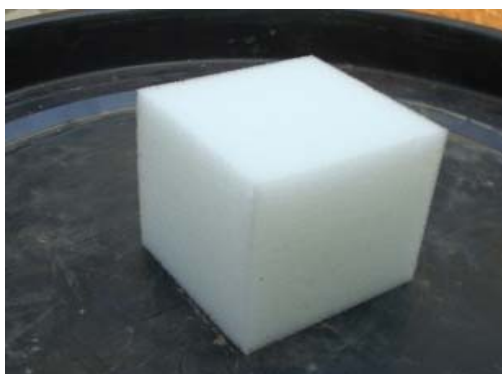
Figura 4.8: Cubos de espuma de poliuretano utilizados como material suporte.
