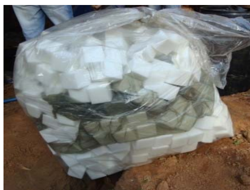
Figura 4.8: Cubos de espuma de poliuretano utilizados como material suporte.
