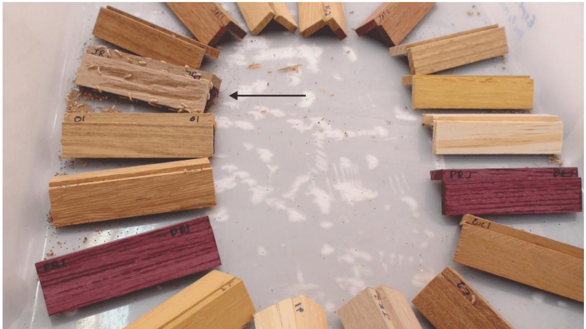
Figura 4: experimento com chance de escolha, cabanas. Seta aponta para jequitibá rosa, altamente atacado. Cabana apresenta uma porta de material celulósico, construída pelos cupins, para vedar a estrutura.
