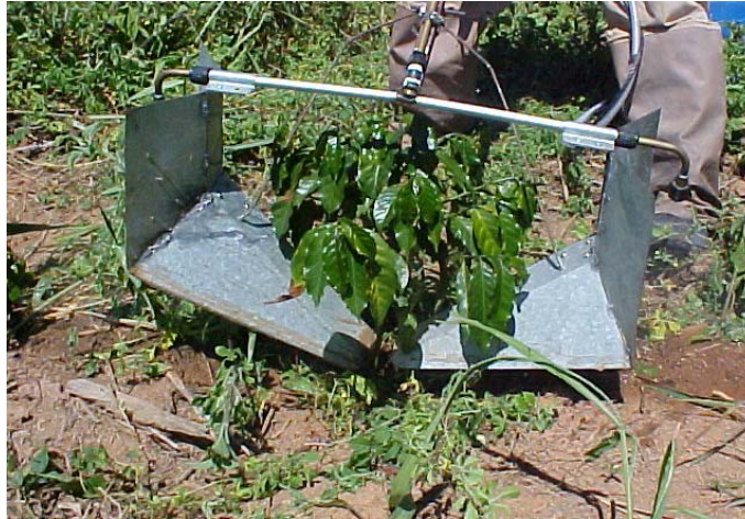
Figura 2. Barra de pulverização com dois bicos e dispositivo protetor
