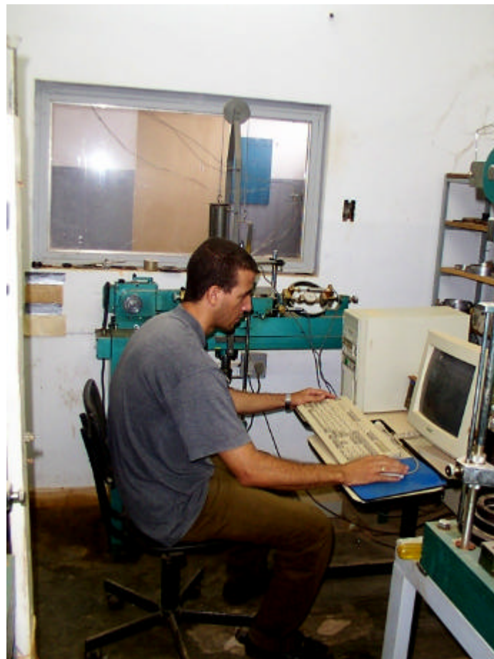
Figura 18. Detalhes do equipamento de cisalhamento direto e do sistema de aquisição de dados empregado.
