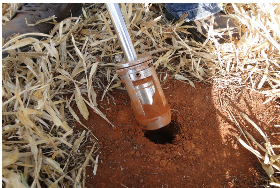
Figura 4 – Retirada da amostra para determinação da densidade do solo com anel volumétrico.
