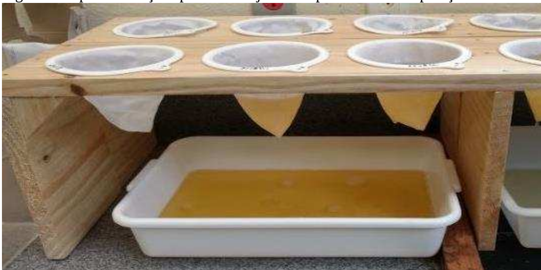
Figura 6 Etapa de filtração após teste de jarros no processo de recuperação da estruvita
