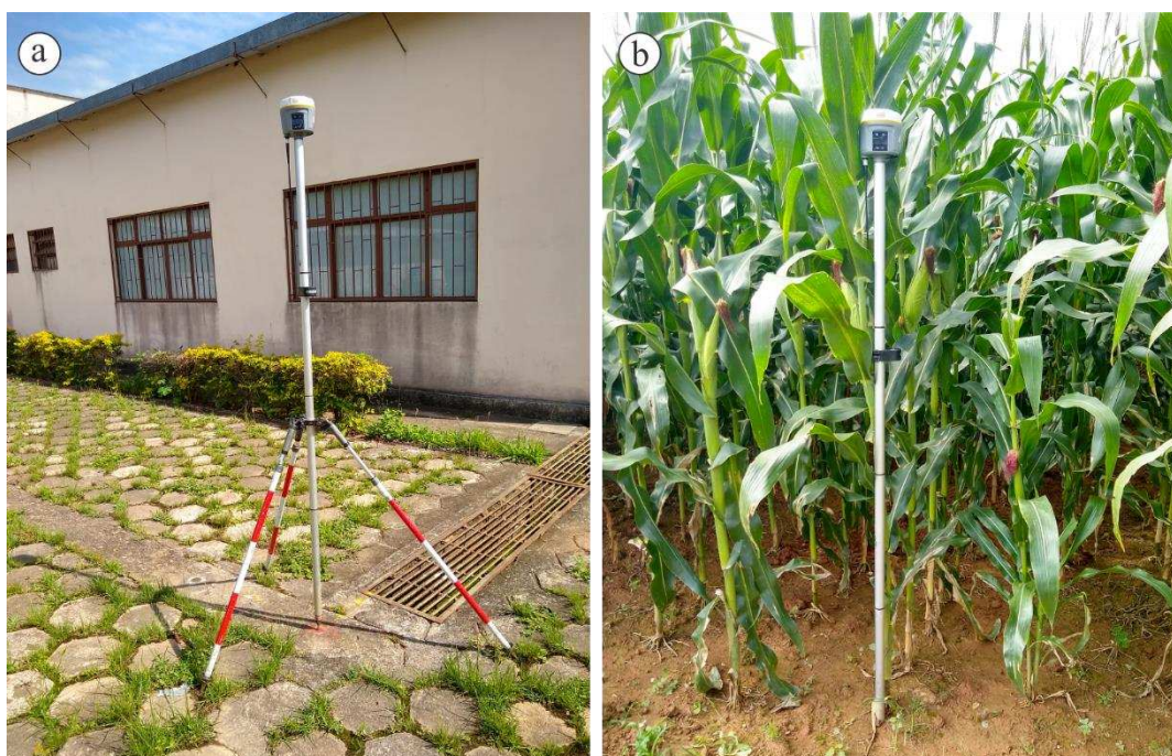
Figura 8: Equipamento RTK utilizado para coleta de pontos georreferenciados: a) base do equipamento; b) rover do equipamento.
