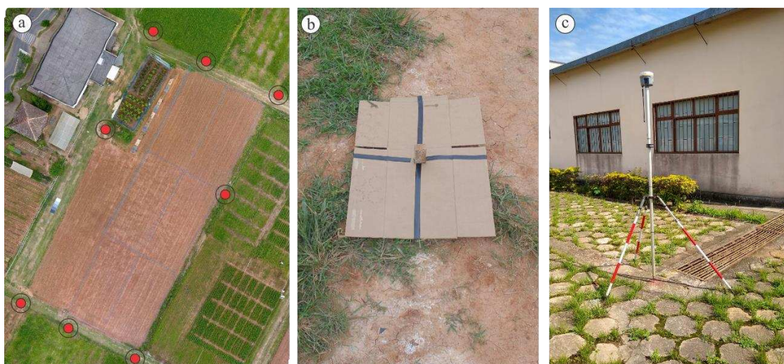
Figura 5: a) Espacialização dos pontos de controle em campo; b) ponto de controle instalado em campo; c) RTK Topmap usado na captura dos pontos de controle.
