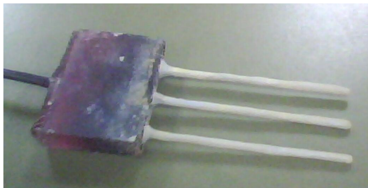
Figura 4.2 – Sensor de teor de água do solo com hastes revestidas com massa epóxi.
