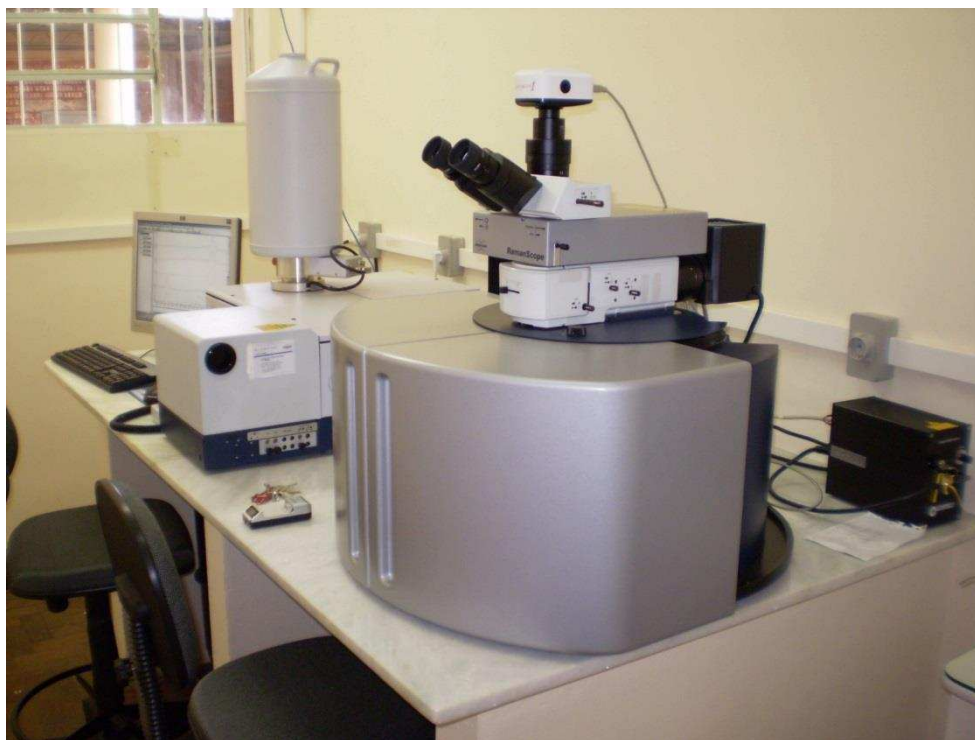
Figura 4 – Espectrômetro RFS 100 FT-Raman (Bruker).
