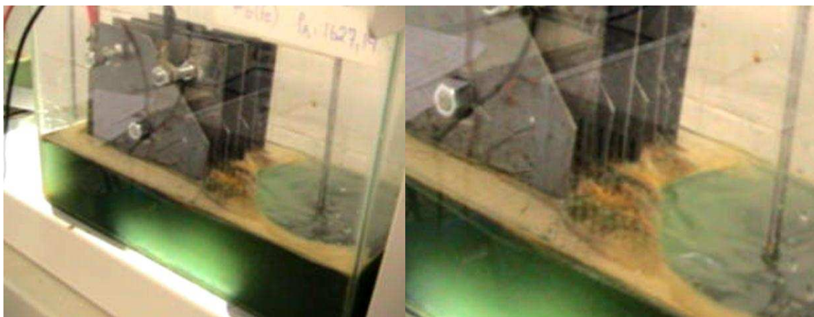
Figura 11 - Montagem real do reator com eletrodos de ferro, aspecto do efluente e do material flotado.
