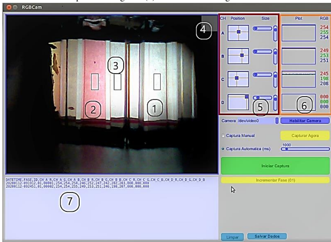
Figura 4.4 – Interface do software para análise das imagens digitais. Áreas para coleta de dados: (1) cubeta com branco; (2) cubeta com amostra; (3) luz incidente; (4) região sem incidência de luz (preto); (5) campos de seleção e ajuste; (6) gráficos com valor de RGB para cada região e (7) valores de RGB registrados.
