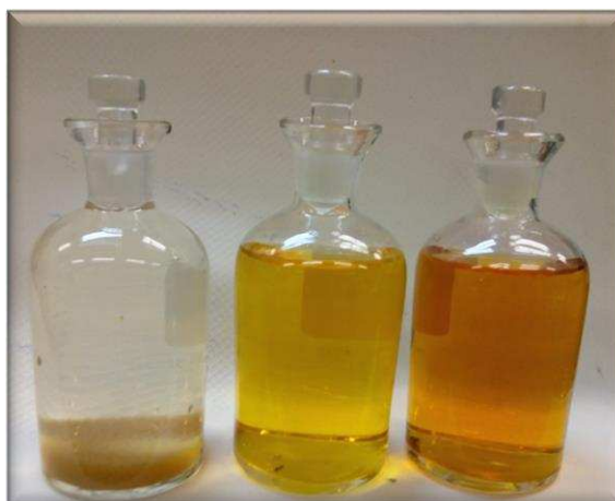
Figura 3.5 – Fotografia de frascos DBO durante execução do método de Winkler. Frascos da esquerda para a direita o primeiro está na etapa de precipitação, já os demais estão na etapa de formação do triiodeto em diferentes concentrações.
