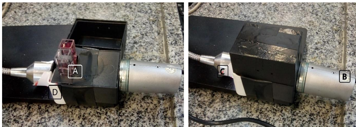
Figura 4.3 – Sistema para análise por imagem digital. (A) orifício para cubetas, (B) webcam , (C) fonte de luz, (D) filtro dispersor
