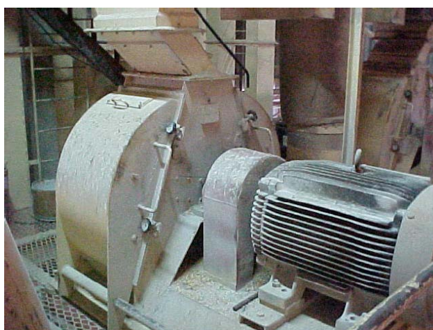
Figura 14. Vista parcial do sistema de moagem dos ingredientes para a fabricação de rações.
