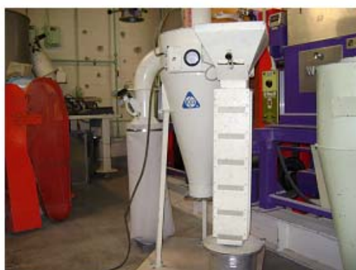
Figure 22. Sistema de aspiração.
