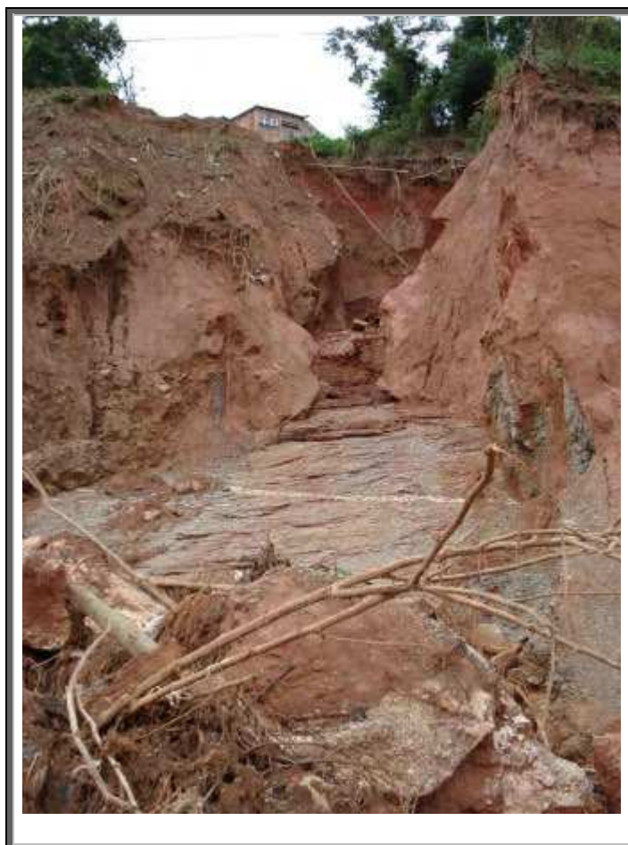
Figura 5.12 – Superfície de deslizamento no contato entre solo e rocha, expondo a rocha com foliação mergulhando no sentido do deslizamento (Fonte: Defesa Civil, 2007).
