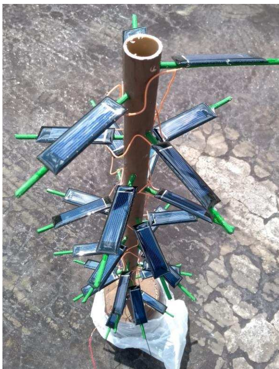
Figura 51 - Vista lateral mostrando sombreamento na Árvore 3.
