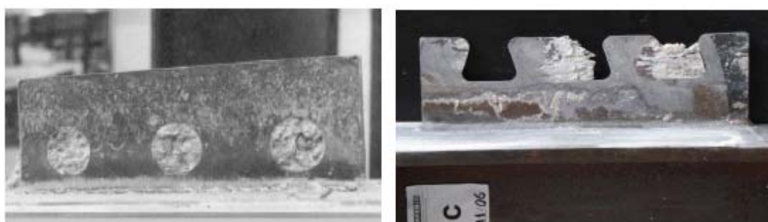
(a) (b) Figura 2-8 – Detalhe do conector após o colapso e o efeito de pino no concreto: a) no Perfobond (Oguejiofor e Hosain, 1994); b) no Crestbond (Veríssimo, 2007).
