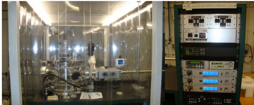
FIGURA 4.2: (a) Configuração da câmara de sputtering onde os filmes são crescidos.(b) Sistema de sputtering RF/DC da empresa AJA International Inc. (Orion 8) localizado no LMF do LNNano, localizado em Campinas, Brasil.
