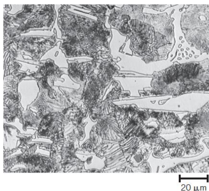
Figura 2.17 – Micrografia do Ferro fundido branco (CALLISTER E RETHWISCH, 2016).
