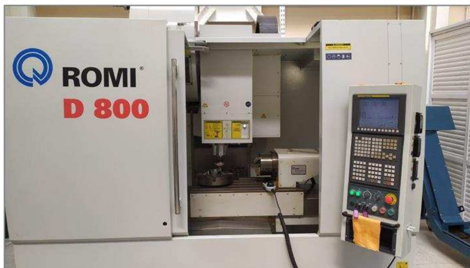
Figura 3.5 - Centro de Usinagem ROMI D800.
