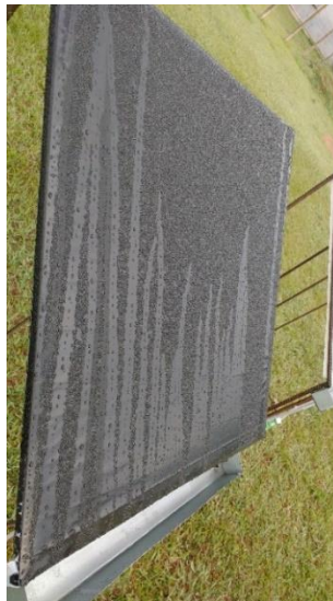
Figura 5.4: Formação de orvalho na superfície condensadora plástico preto.
