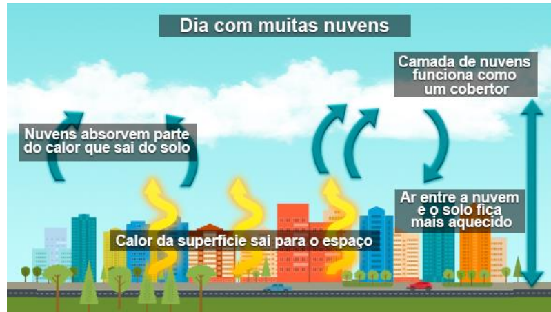
Figura 2.2: Influência da nebulosidade no processo de resfriamento radiativo passivo. Fonte: PERGORIM (2016).
