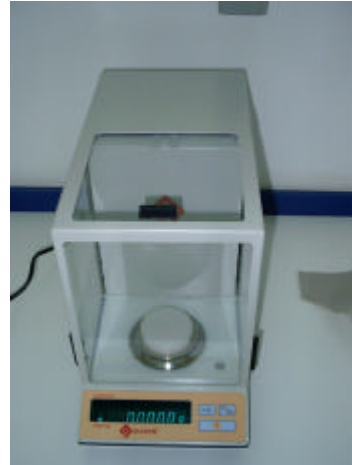
Figura 20 – Representação da pesagem dos papéis-filtros após estufa com resfriamento das cápsulas em bloco de alumínio, em balança de precisão.
