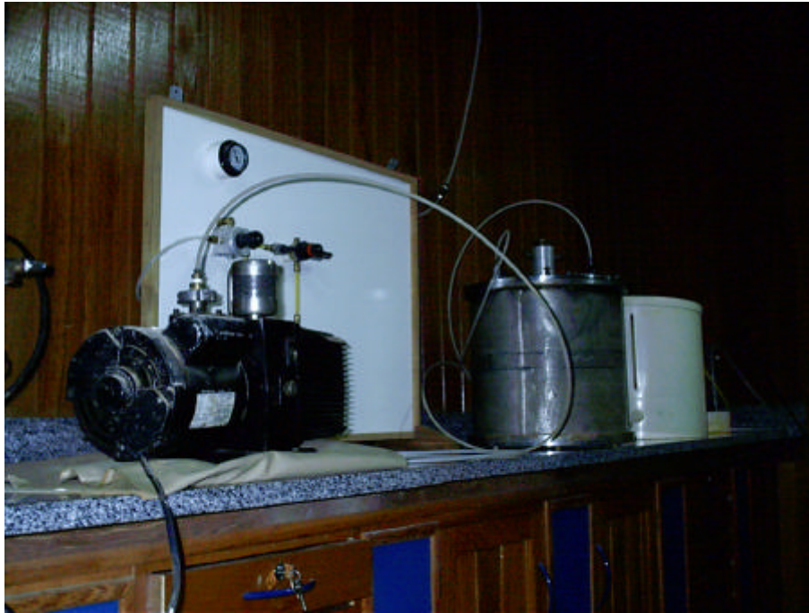
Figura 21 – Processo de saturação dos corpos-de-prova através de aplicação de vácuo.
