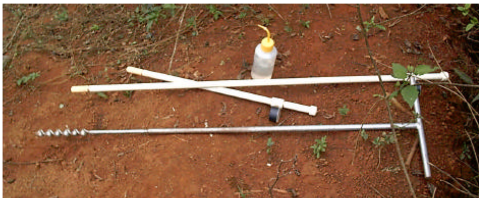
Figura 9 – Tensiômetros e trado utilizado nas suas instalações nos solos em estudo.
