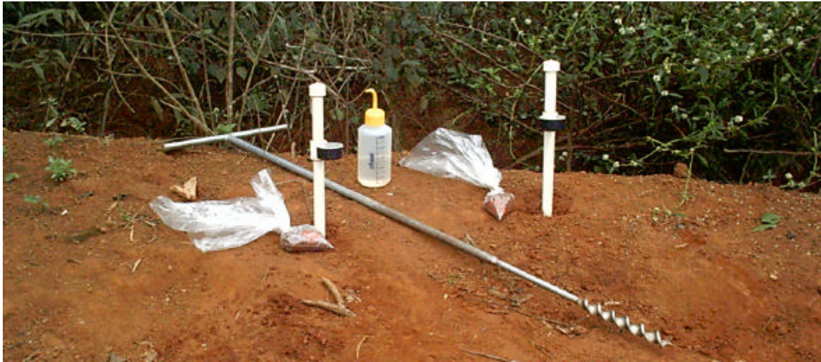
Figura 14 – Foto dos tensiômetros instalados no talude VG.
