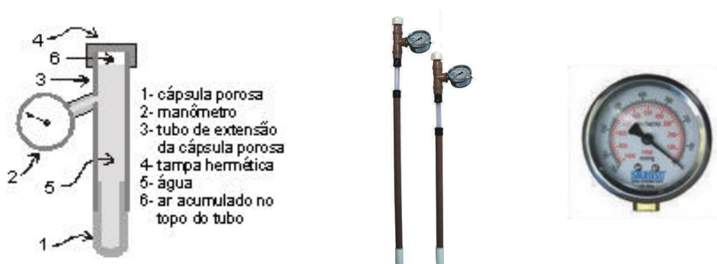
Figura 4 – Tensiômetros convencionais com vacuômetro.
