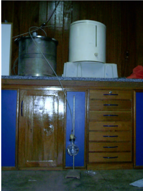
Figura 23 – Aparelhagem para ensaio de câmara de pressão, com aplicação de pressão de ar dentro de uma panela de pressão.
