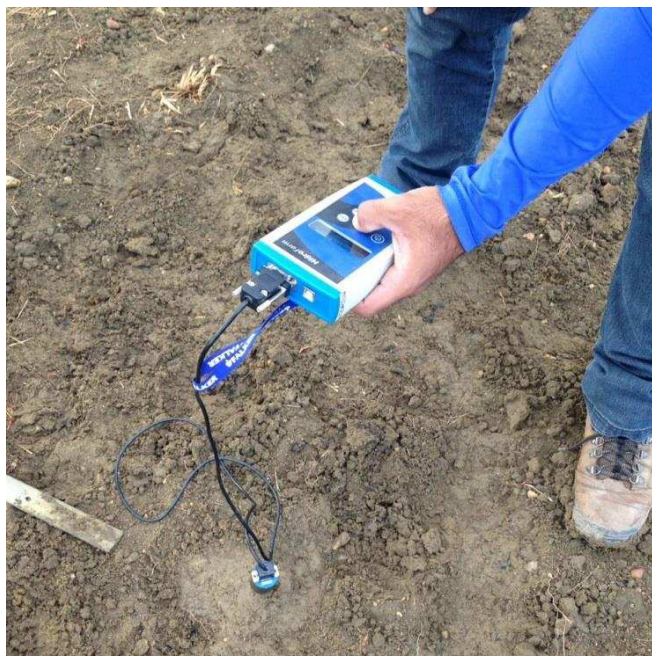
Figura 1. Monitoramento do teor de água do solo utilizando o medidor eletrônico HidroFarm, modelo HFM2130.
