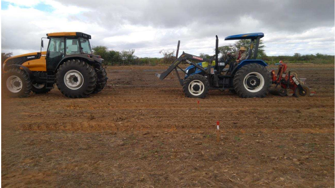
Figura 11. Determinação da força de tração requerida pelo método do comboio.
