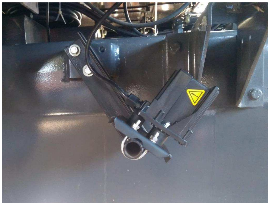
Figura 8. Radar usado no monitoramento da velocidade do trator.
