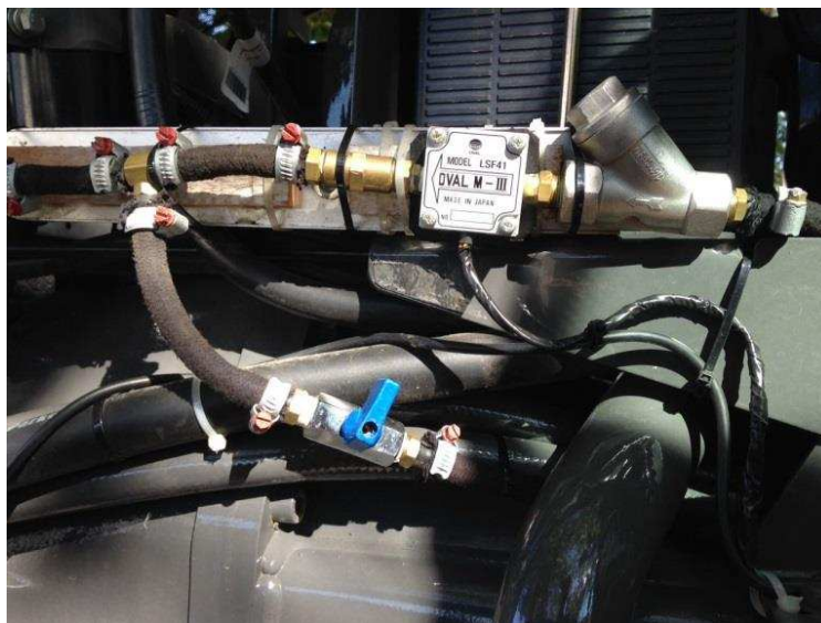
Figura 1. Fluxômetro utilizado na determinação do consumo horário de combustível.
