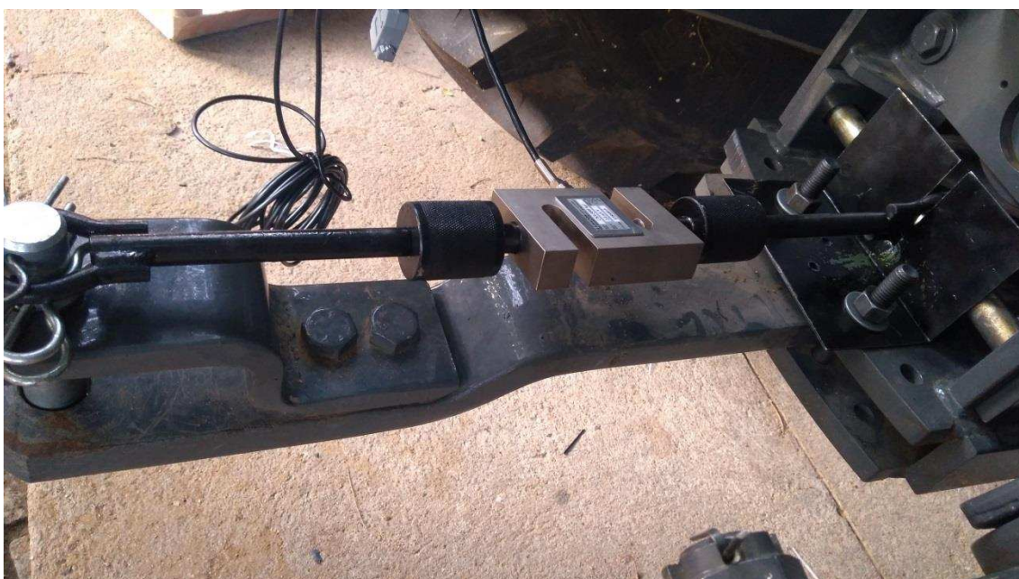
Figura 10. Célula de carga e suporte usados na instalação.
