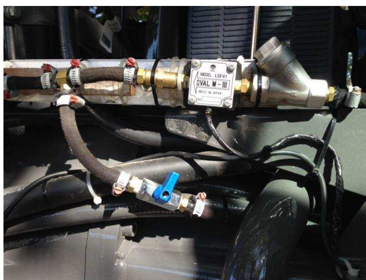
Figura 9. Fluxômetro utilizado na determinação do consumo de combustível.
