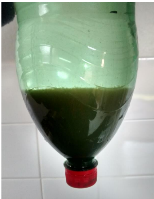
Figura 9 - Lodo obtido a partir de dez ensaios de jarros com sulfato de alumínio
