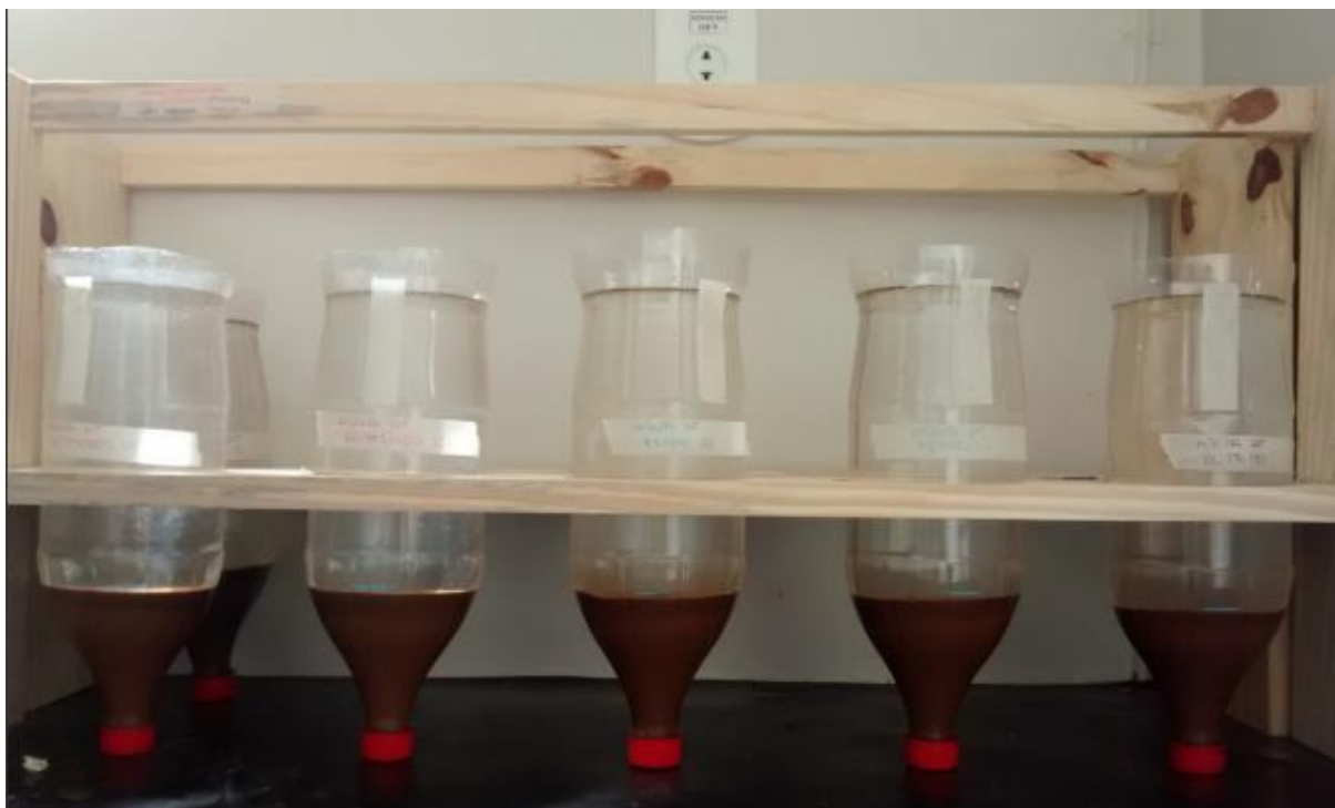
Figura 25 - Garrafas com água decantada e lodo sedimentado ao término dos ensaios de jarros com água de alta turbidez. Da esquerda para direita: garrafas 1 e 2 - lodo de sulfato de alumínio; garrafas 3 e 4 - lodo de cloreto férrico; garrafas 5 e 6 (atrás) - lodo da mistura de coagulantes.
