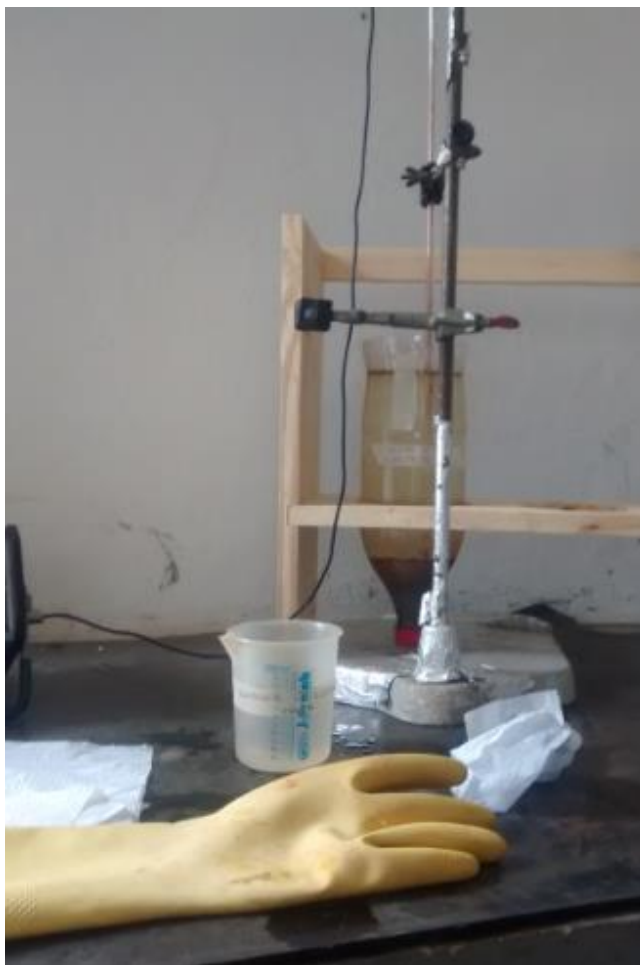
Figura 10 - Medida de potencial redox durante monitoramento do experimento
