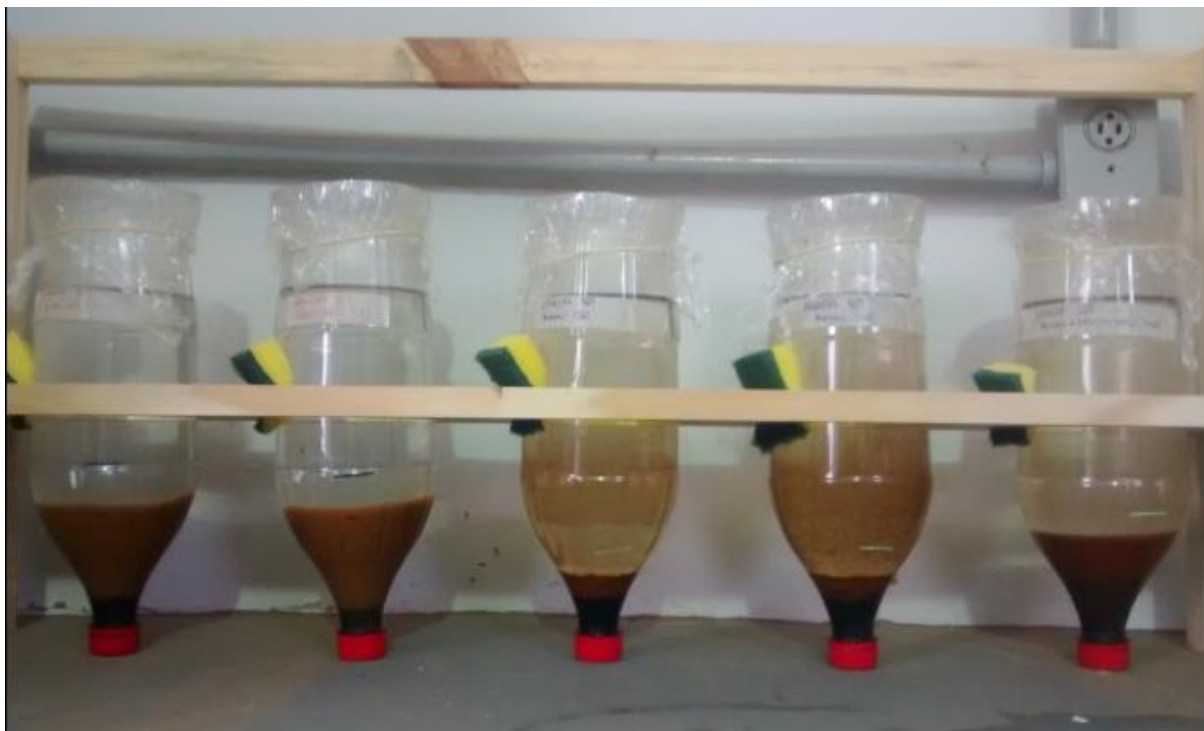
Figura 12- Garrafas com água decantada e lodo sedimentado em ensaios de jarros com água de baixa turbidez após cinco meses. Da esquerda para direita: garrafas 1 e 2 - lodo de sulfato de alumínio, garrafas 3 e 4 - lodo de cloreto férrico; garrafa 5 - lodo da mistura de coagulantes
