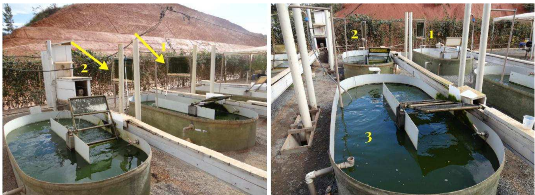
Figura 7.1 – Posicionamento dos três sistemas avaliados: (1) sistema híbrido 1 com suplementação de CO 2 ; (2) sistema híbrido 2; (3) LAT com suplementação de CO 2 .
