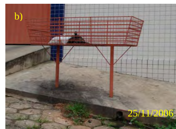
Figura 13 – a) Cachorro espalhando o lixo; b) Lixeira em formato de grade – o lixo espalhado no chão, é carregado pela chuva
