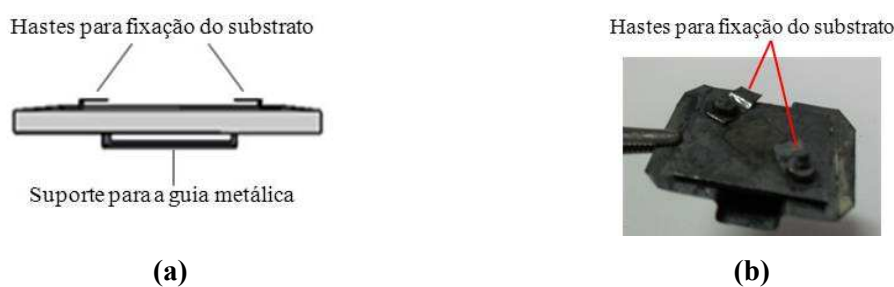
Figura 3.1 - (a) esquema e (b) foto do porta-substrato
