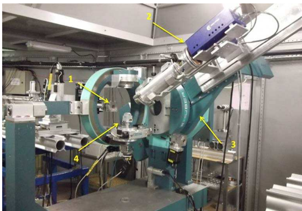
Figura 3.6 - Goniômetro da marca HUBER que compõe a linha XRD2 do LNLS, em: (1) a saída do feixe incidente, (2) o detector, (3) o braço 2\theta e (4) a cabeça goniométrica [25]
