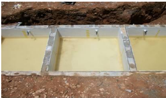
Figura 41 – Reator de desinfecção por radiação solar SODIS, operando com três lâminas diferentes.
