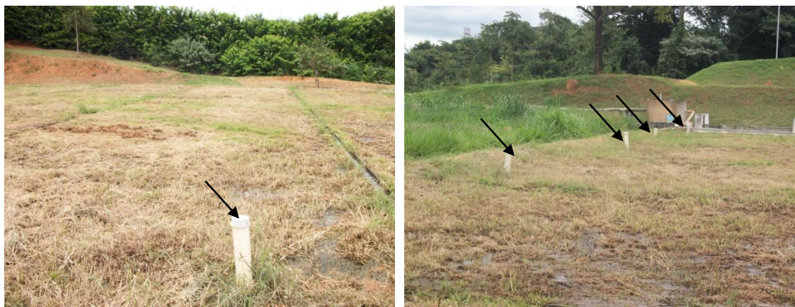
Figura 21- Coletores semi-abertos utilizados para determinar perdas de nitrogênio por volatilização da amônia.
