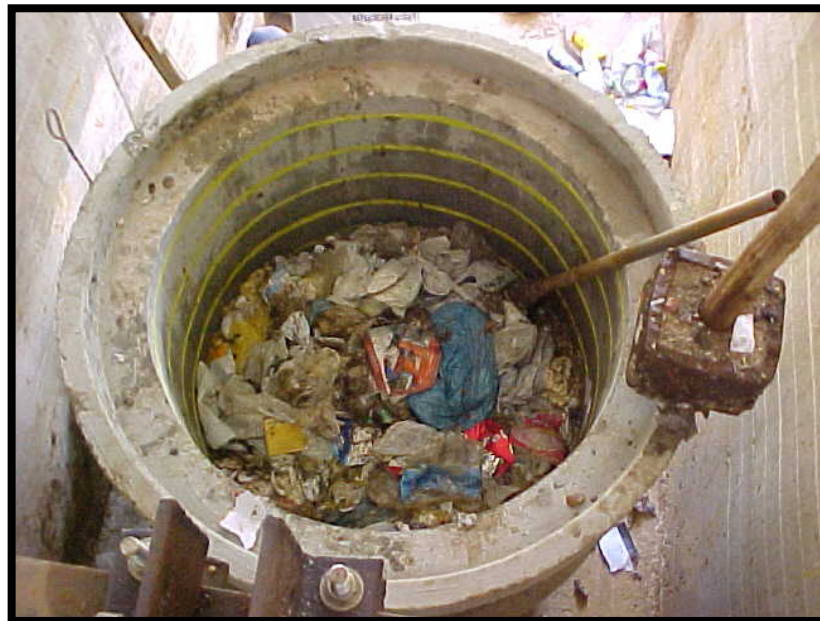
Figura 15 – Compactação dos RSU na manilha.
