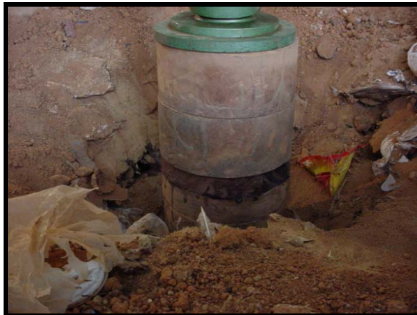
Figura 22 – Detalhe da sapata durante o ensaio.
