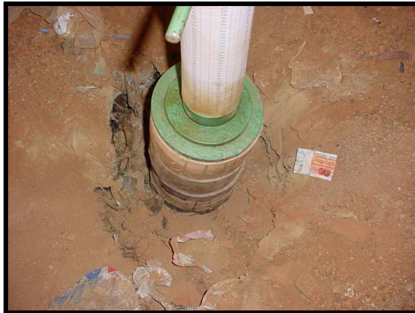
Figura 21 – Vista superior da sapata, mostrando a deformação dos resíduos.
