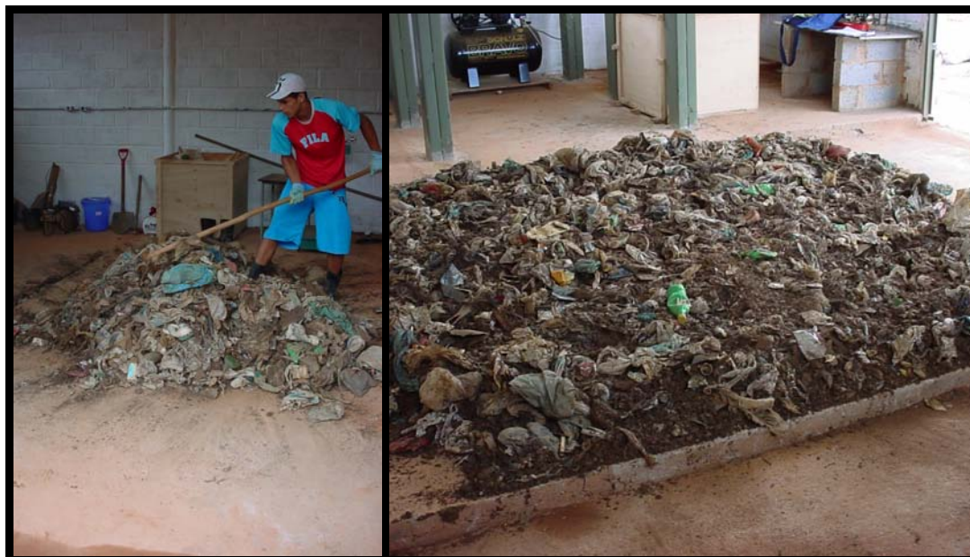
Figura 33 – Amostra sendo misturada e espalhada para secagem.
