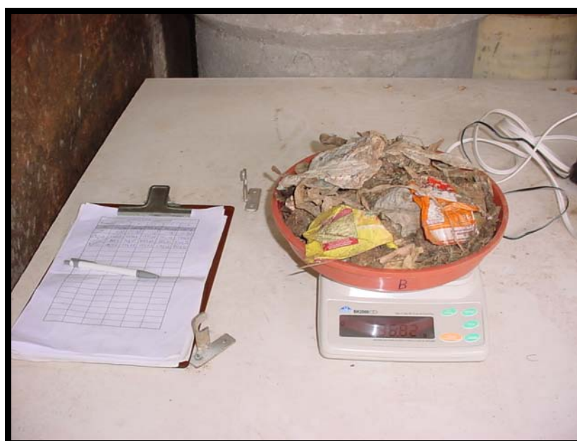
Figura 23 – Determinação da massa bruta úmida dos RSU.
