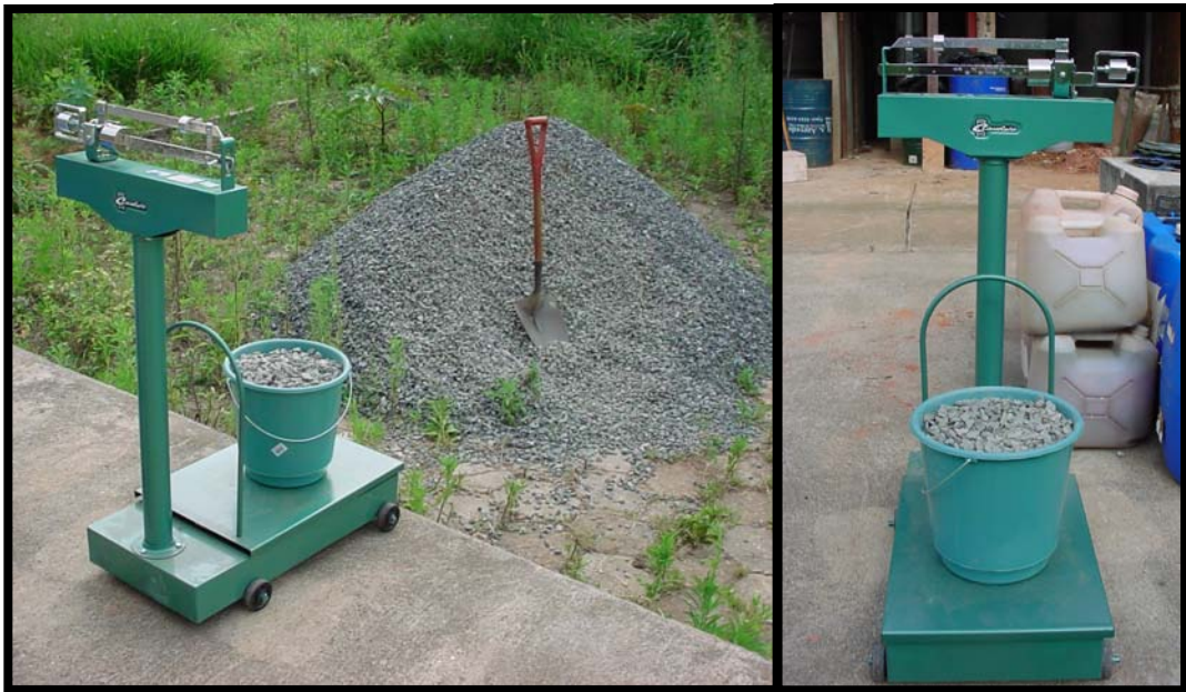
Figura 17 – Pesagem da brita para as etapas de carregamento.
