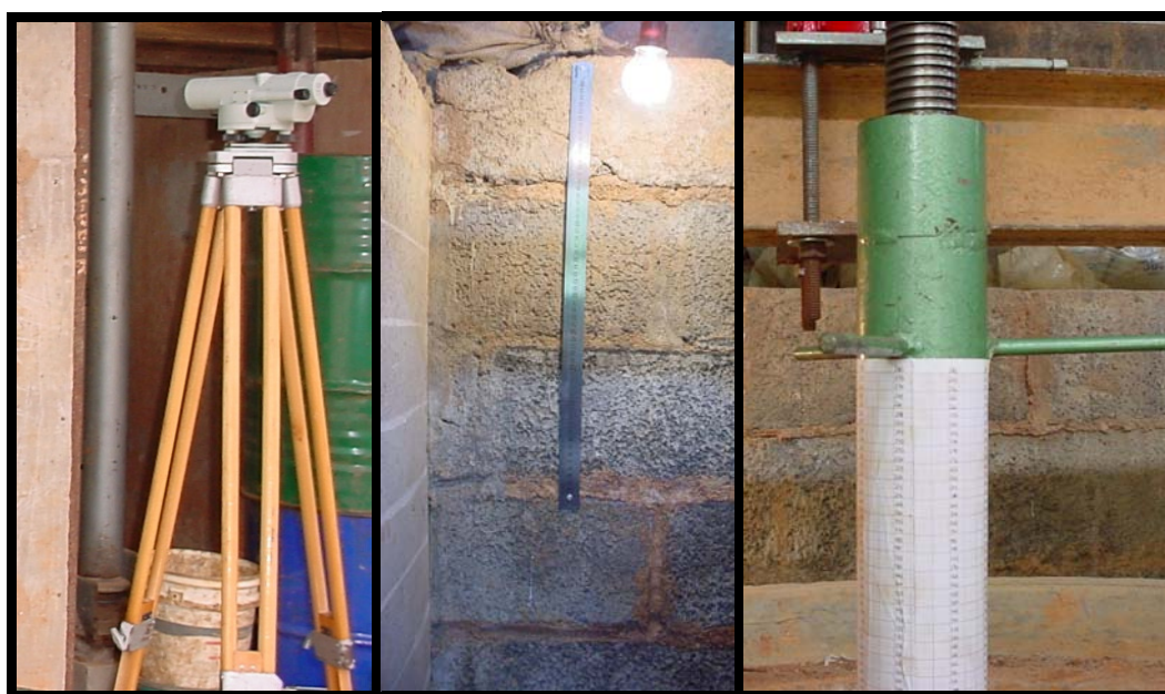
Figura 19 – Detalhe do aparelho de nível de placas paralelas, da régua fixa na parede e do eixo de carregamento com papel milimetrado.
