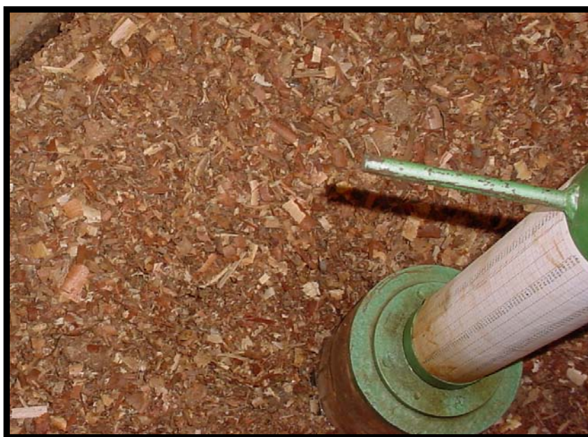
Figura 16 – Cobertura dos resíduos após a compactação em camadas.
