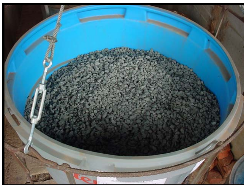
Figura 12 – Enchimento da caixa para aplicação do peso estático.
