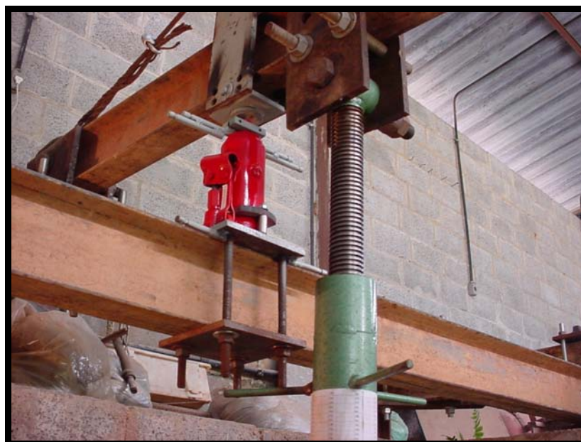
Figura 14 – Detalhe do eixo regulável de aplicação de carga.
