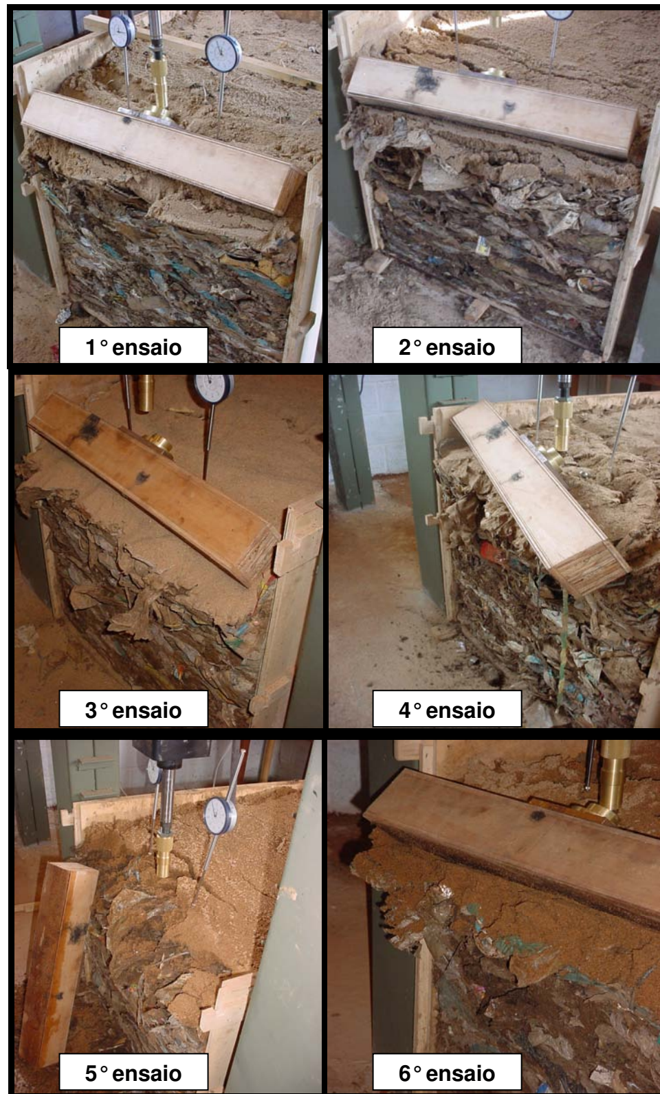
Figura 35 – Detalhe da ruptura em todos os ensaios.
