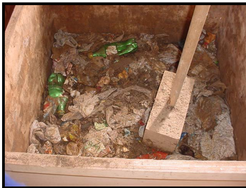
Figura 30 – Compactação dos RSU na caixa em camadas.
