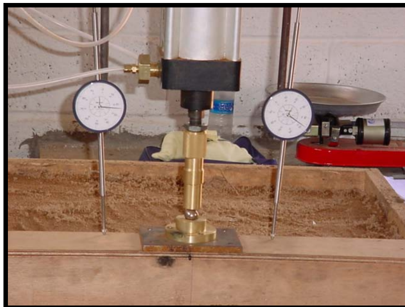
Figura 32 – Relógios medidores de deslocamentos apoiados na sapata.
