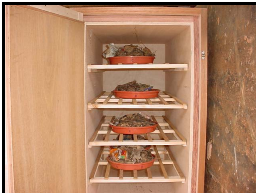
Figura 24 – Amostras na estufa para determinação do teor de umidade dos RSU.
