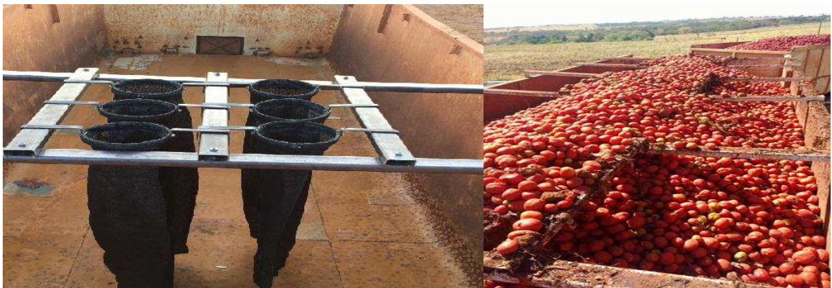
Figura 3. Coletor de amostras de cargas a granel instalado na caçamba do caminhão antes da colheita mecanizada.
