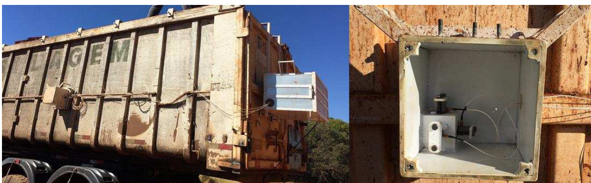
Figura 1. Acelerômetros e sistema de aquisição de dados montados em um recipiente de transporte.
