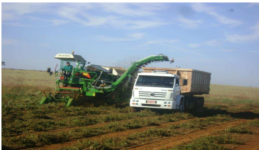
Figura 3. Sistema 3 composto por colhedora, caminhão e caçamba.
