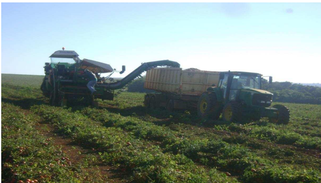
Figura 2. Sistema 2 composto por colhedora, trator, reboque e caçamba.
