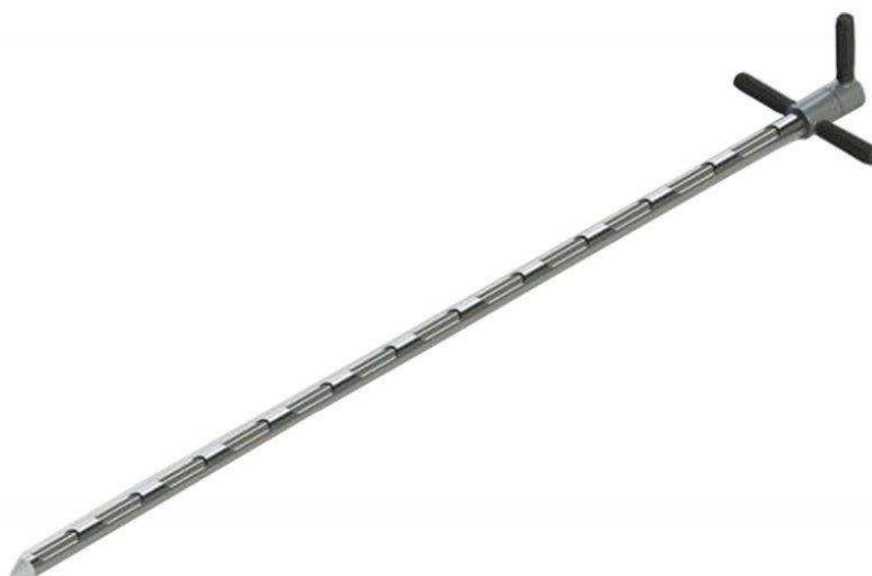
Figura 2. Calador de grãos para cargas a granel.
