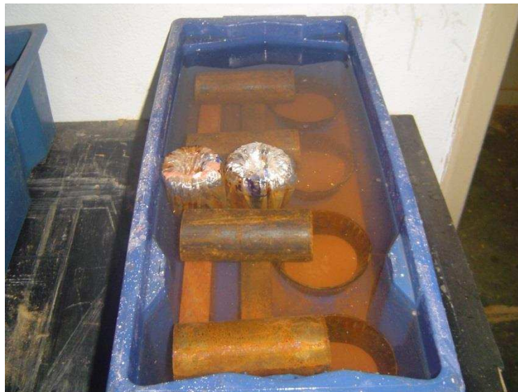
Figura 3.23 - Utensílios utilizados para execução do ensaio de perda de massa por imersão.
