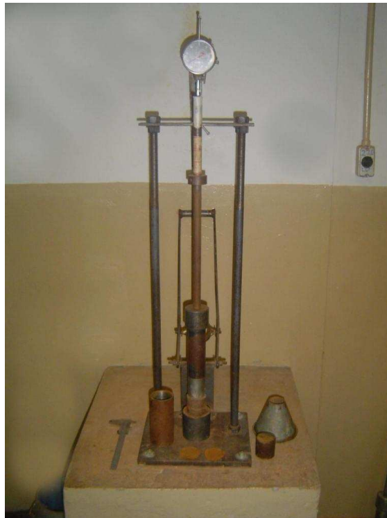
Figura 3.22 - Equipamento de compactação utilizado para a realização do ensaio mini-MCV.
