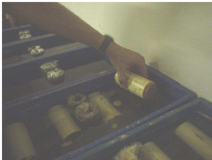
Figura 2.15 - Amostra sendo colocada no tanque de imersão
