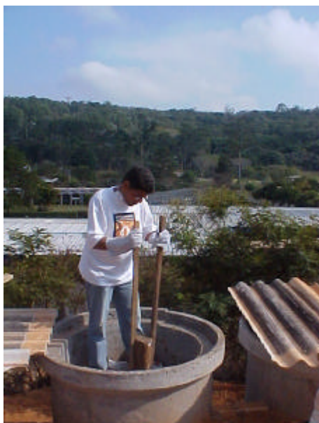
Figura 18 – Compactação dos resíduos com o soquete de madeira.
