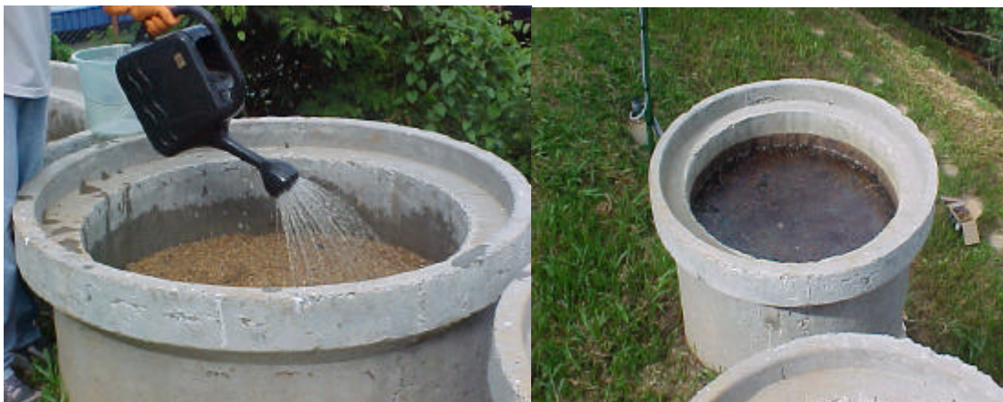
Figura 23 – Sistema de recirculação e lâmina do líquido percolado aplicada sobre os lisímetros.
