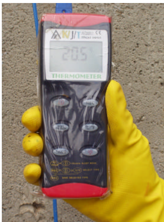
Figura 20 - Equipamento utilizado no monitoramento da temperatura na massa de resíduos.
