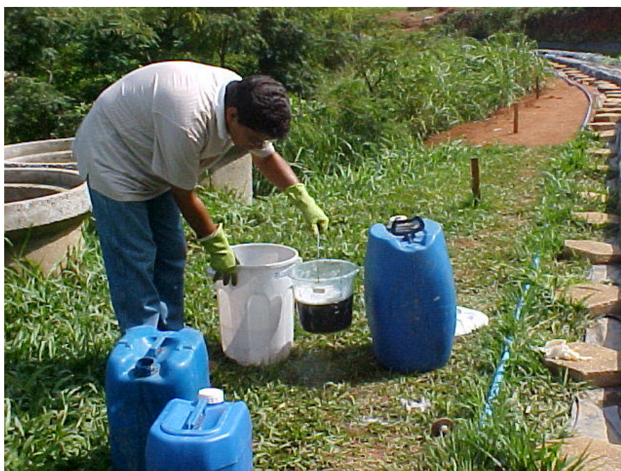
Figura 22 – Armazenamento do percolado drenado dos lisímetros.
