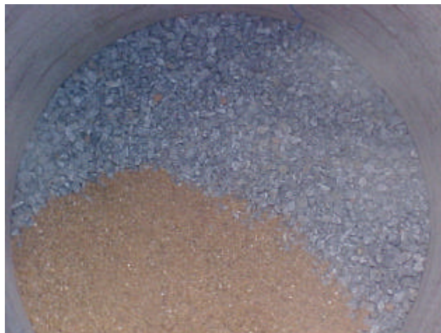
Figura 12 – Camada de drenagem na base dos lisímetros.
