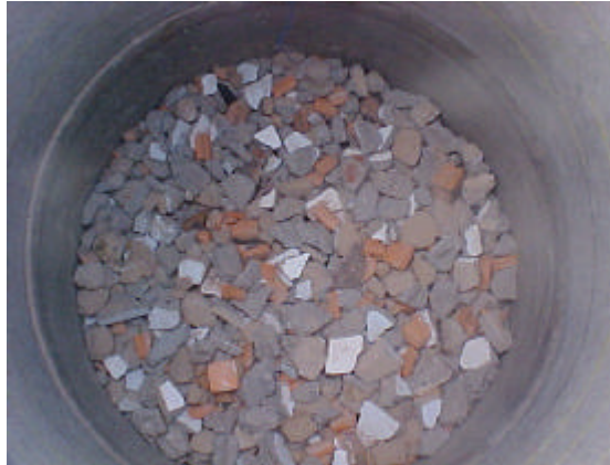
Figura 13 – Camada de resíduos de construção civil sobre a camada de drenagem na base dos lisímetros.
