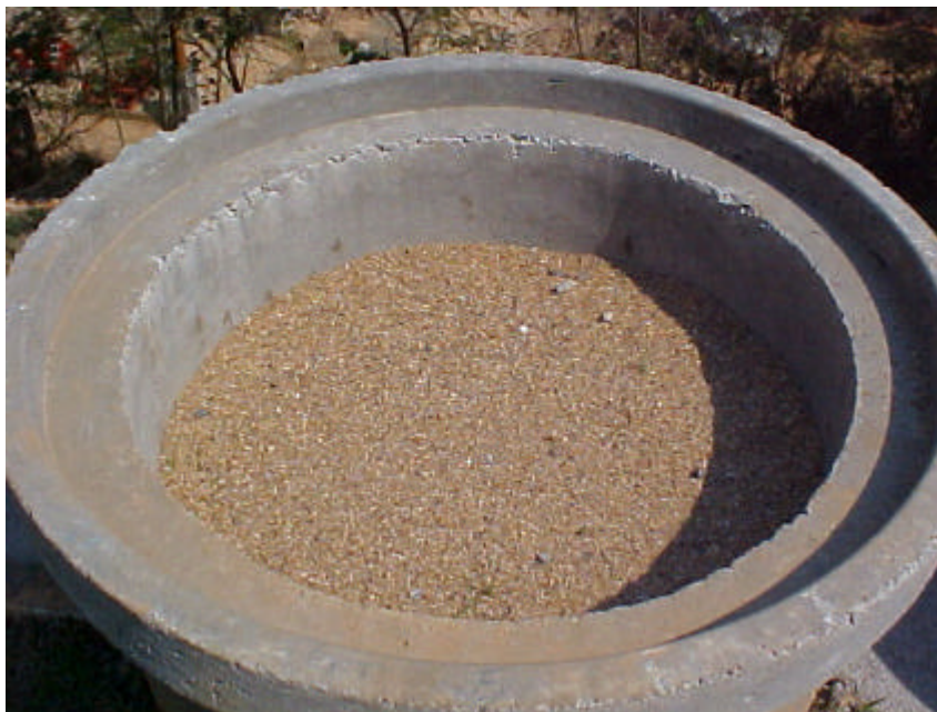
Figura 15 – Camada de cobertura do lixo nos lisímetros.
