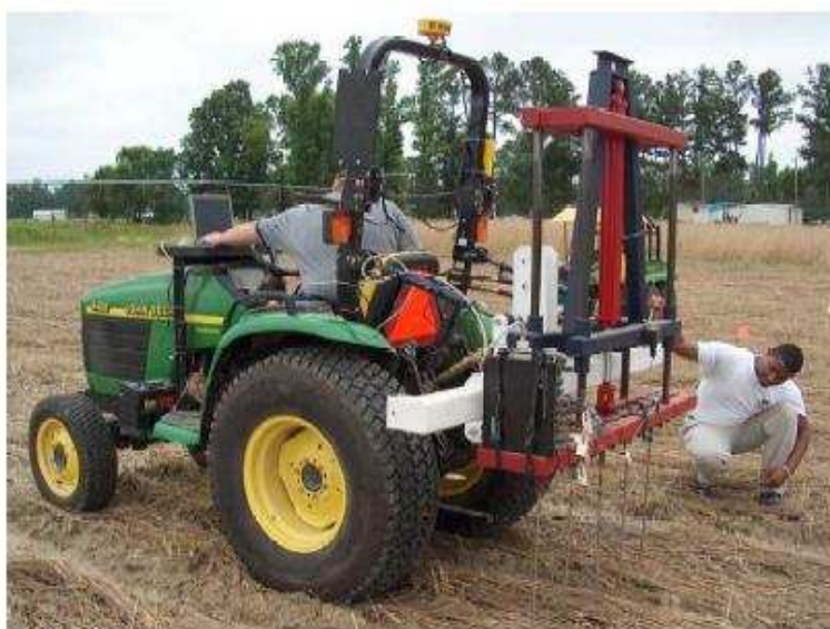
Figura 2 - Penetrômetro de cone de solo de múltiplas sondas (MPSCP) com cinco sondas e sistema GPS para medição de índices de cone em solo de argila arenosa Pacolet em Auburn, AL
