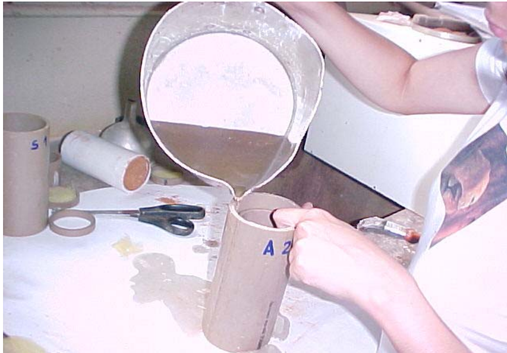
Figura 16 – Detalhe do preenchimento do espaço entre a coluna de solo e o cilindro de PVC.
