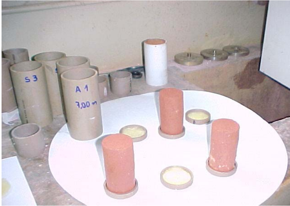
Figura 14 – Colocação do corpo de prova sobre o anel de PVC.
