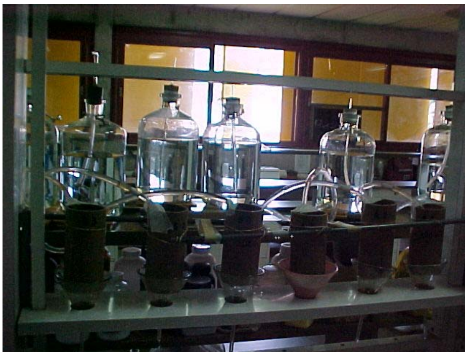
Figura 20 – Detalhe do sistema em operação, com os corpos de prova recebendo o “coquetel” de metais pesados, para a ocorrência do escoamento permanente, em condições de saturação.
