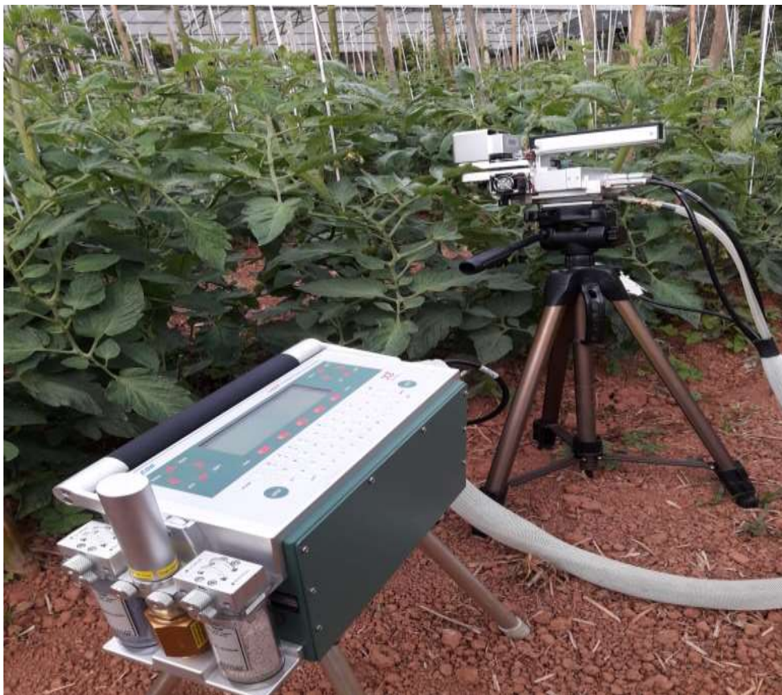
Figura 4: Foto do Infra Red Gas Analyser (IRGA), modelo portátil LI-6400, LI-COR Biosciences Inc., Lincon, Nebraska, USA em uso na Unidade Experimental de Pesquisa e Extensão (UEPE UFV); Viçosa-MG,2017/2018.
