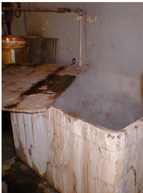
Figura 20 - Detalhe da injeção do vapor na escória "D"
