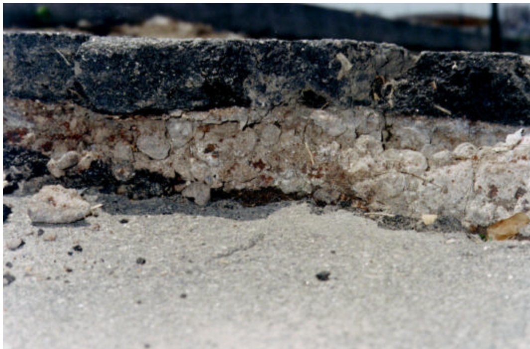
Figura 2 - Resultado da expansão provocada pela oxidação das partículas metálicas e hidratação dos óxidos cálcio e/ou magnésio
