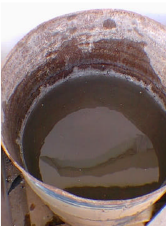
Figura 17 - Escória "C" imersa em água durante todo período de ensaio
