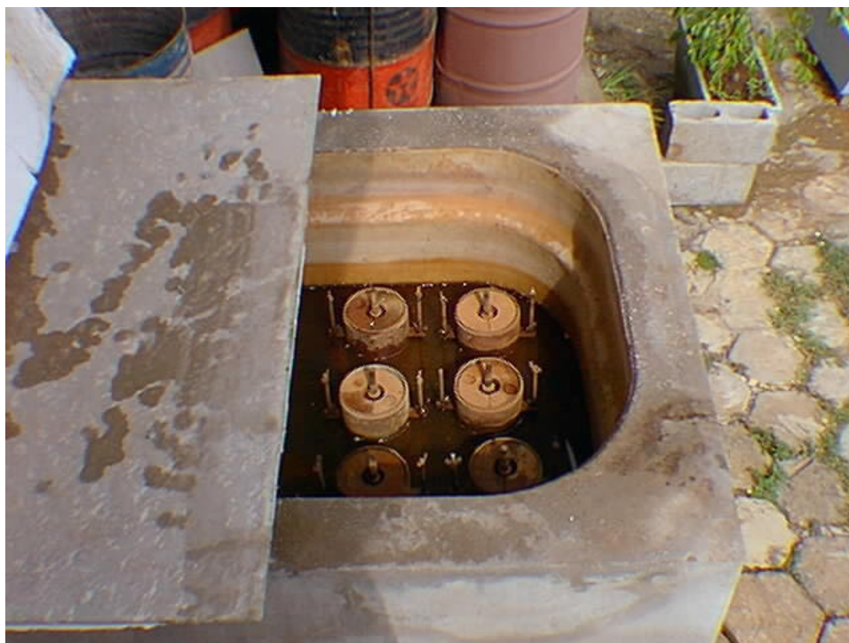
Figura 22 - Vista interna do tanque onde foram feitas as leituras de expansão.
