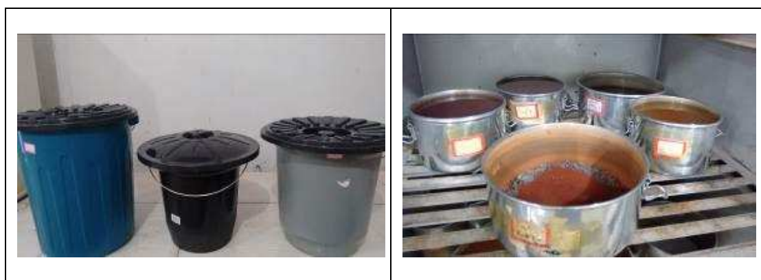
Figura 26: Material coletado nos baldes para sedimentação e depois transferido para vasilhas de alumínio levadas à estufa por 24 horas.
