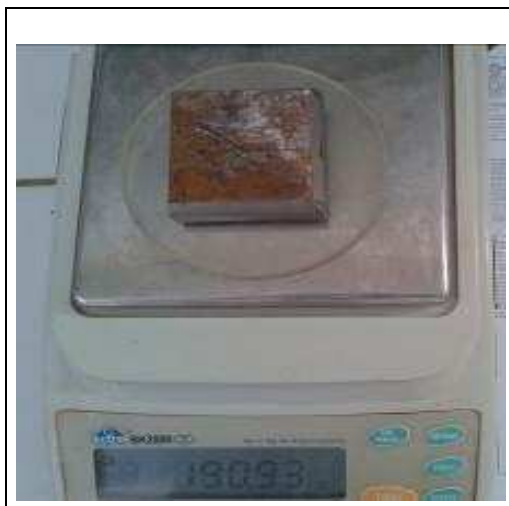
Figura 19: Amostra indeformada, moldada e pesada antes do ensaio de cisalhamento direto.
