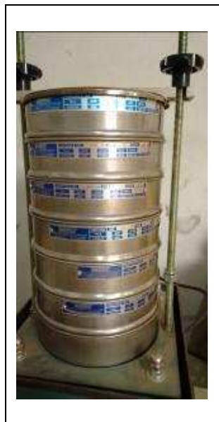
Figura 27: Conjunto de peneiras utilizadas.
