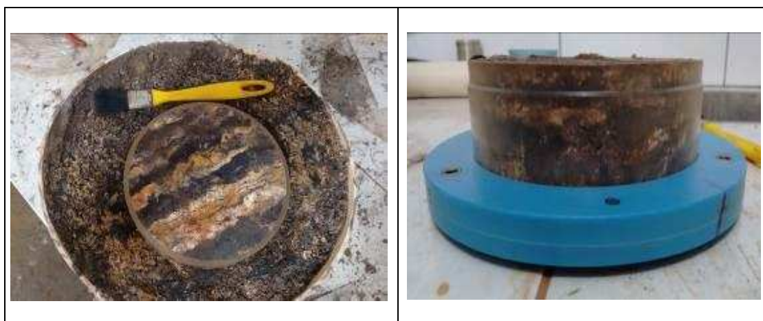
Figura 20: Amostra indeformada, moldada para a realização do ensaio de Inderbitzen.
