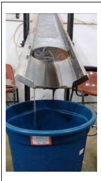
Figura 23: Balde identificado no qual se coletou a água e o material carreados.
