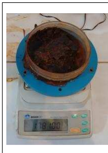
Figura 25: Pesagem do material que restou no amostrador após o ensaio.
