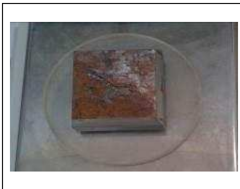
Figura 28: Corpo de prova moldado com o auxílio de um amostrador quadrado.
