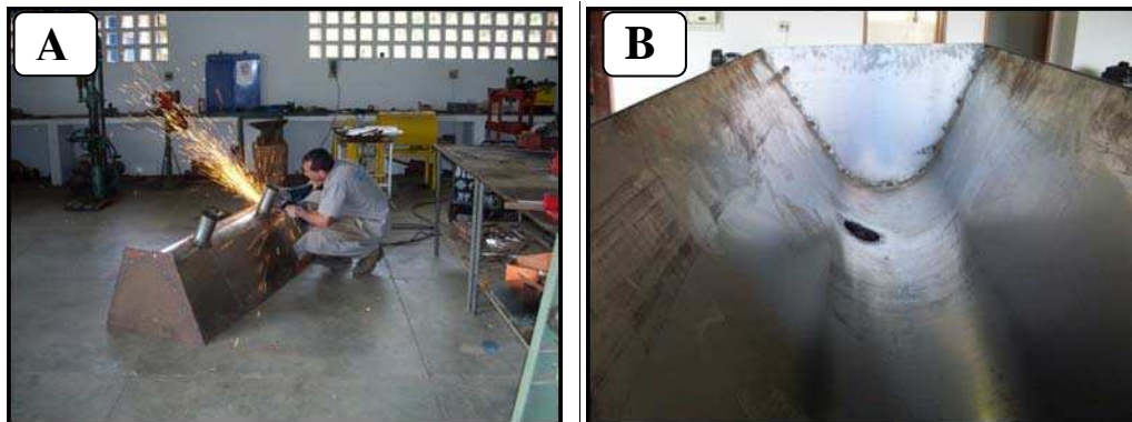
Figura 3 – Confecção da caixa de distribuição de composto orgânico (A). Detalhe interno da caixa com a saída de composto orgânico (B).
