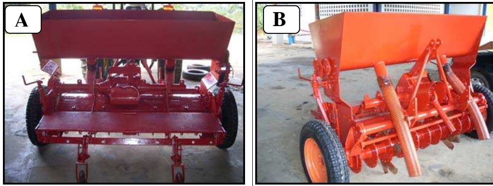
Figura 6 – Adubadora após o trabalho de pintura (A). Detalhe dos tubos de decida do composto orgânico (B).
