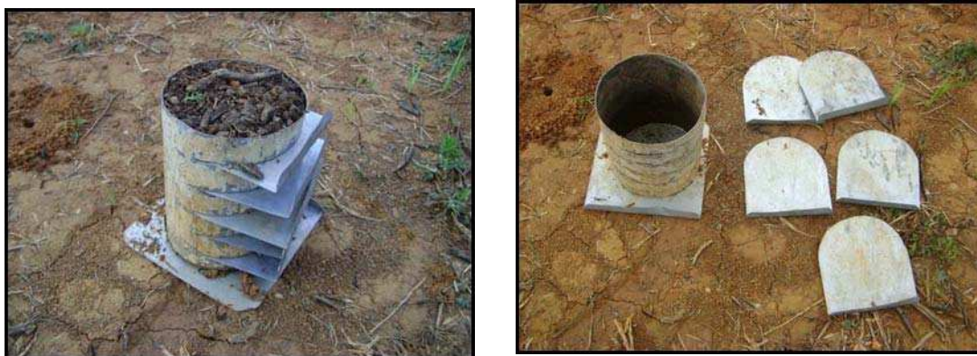
Figura 11 – Tubo utilizado para a coleta das amostras de solo para a determinação do carbono orgânico.
