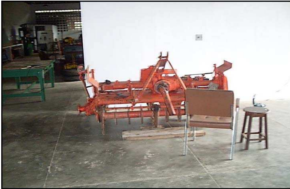
Figura 2 – Chassi da semeadora-adubadora FNI-HOWARD Rotacaster após a desmontagem e limpeza.
