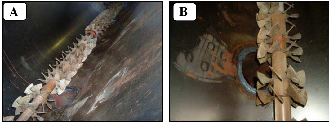
Figura 4 – Eixo de movimentação e transporte do composto orgânico (A). Detalhe do eixo de movimentação e transporte do composto orgânico sobre o orifício de saída (B).
