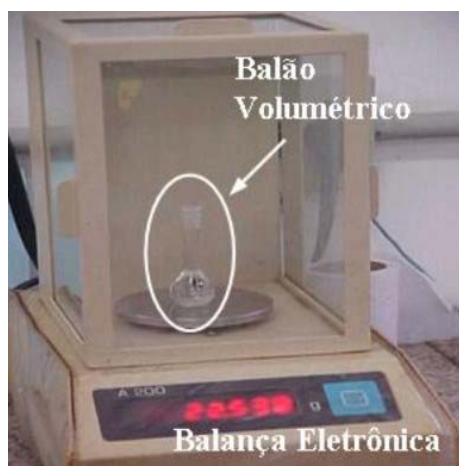
Figura 12. Balança e utensílios utilizados para o cálculo da massa específica.
