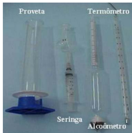
Figura 12. Balança e utensílios utilizados para o cálculo da massa específica.
