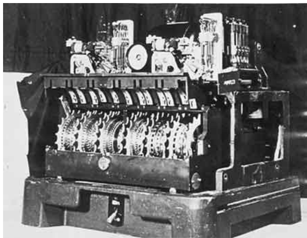
Figura 1.5: Máquina alemã Lorenz
