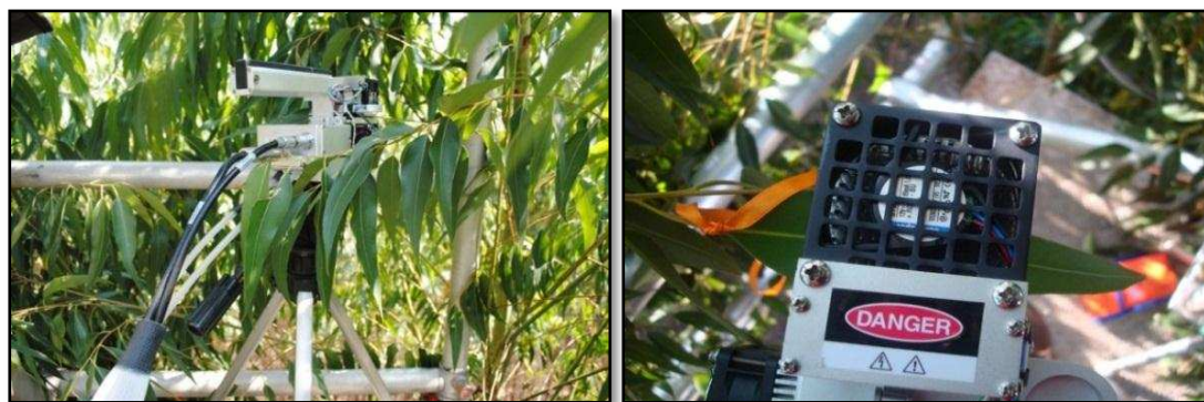
Figura 4 - Medidas das trocas gasosas em folhas de eucalipto com o analisador de gás ao infravermelho.
