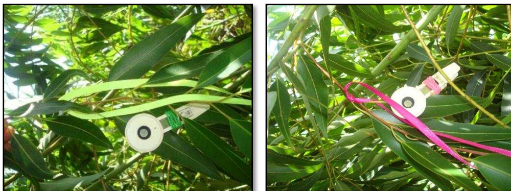
Figura 5 – Adapta\u00e7\u00e3o no escuro de folhas de eucalipto com aux\u00edlio de pin\u00e7as para as medidas de fluoresc\u00eancia.
