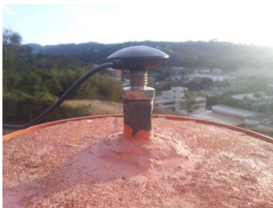
Figura 14 – GPS G-STAR instalado no marco do IBGE.
