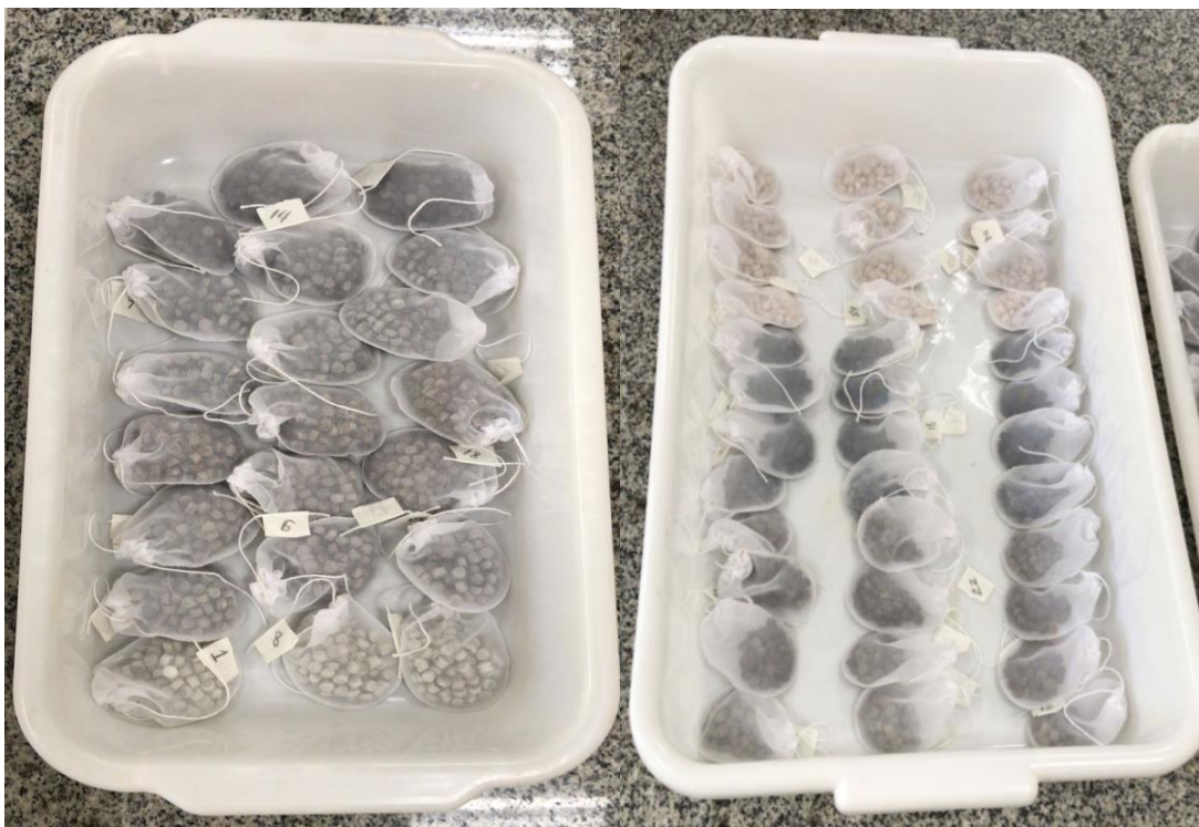
Figura 2 - “Mini-bags” contendo amostras de fertilizantes para avaliação de higroscopicidade.
