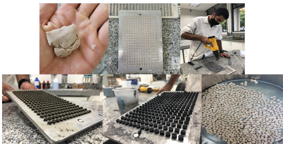
Figura 1 – Ilustração das etapas da produção dos fertilizantes (NPK + S) e nanomateriais pelo método de compactação.
