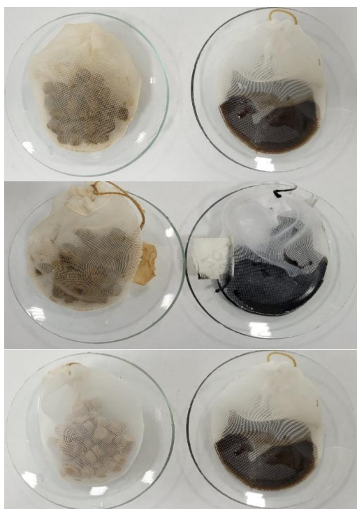
Figura 7 - Análise de higroscopicidade dos fertilizantes. Fertilizantes dispostos nas placas de petri a esquerda mostra os grânulos antes da deterioração e da direita após sofrer este processo.
