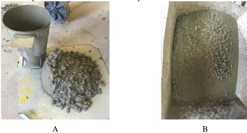
Figura 5 - Slump test de amostra de concreto com plastificante
