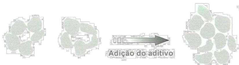
Figura 1 - Ação do aditivo plastificante sobre as partículas de cimento
