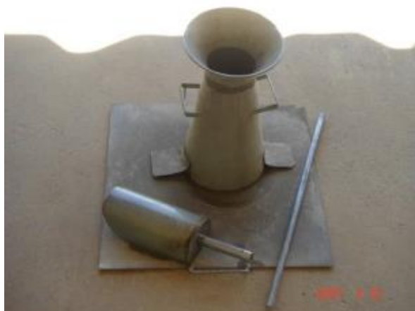
Figura 3 - Materiais utilizados para medição do abatimento do concreto
