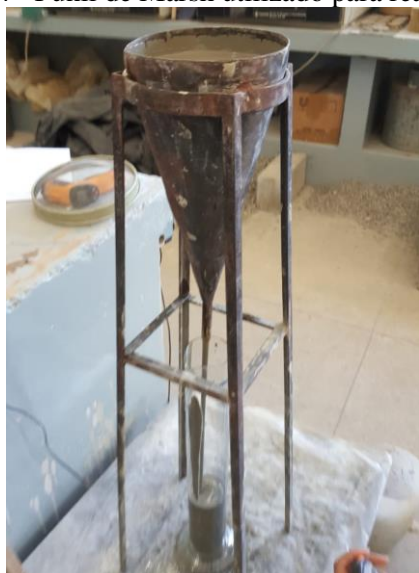
Figura 4 - Funil de Marsh utilizado para realização do ensaio de vida útil do concreto
