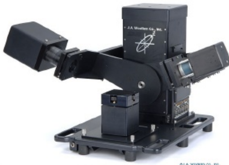
Figura 3.5.3 - Rotating Compensator Ellipsometer (RCE) usado para as medidas óticas.
