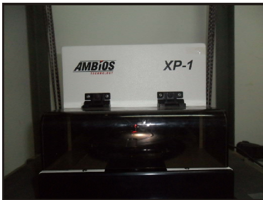
Figura 3.3.1 – Imagem do perfilômetro XP-1 usado para fazer as medidas de espessura.
