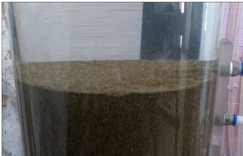
Figura 13 – Presença de flocos na superfície do leito filtrante de areia de britagem (carreira 2)
