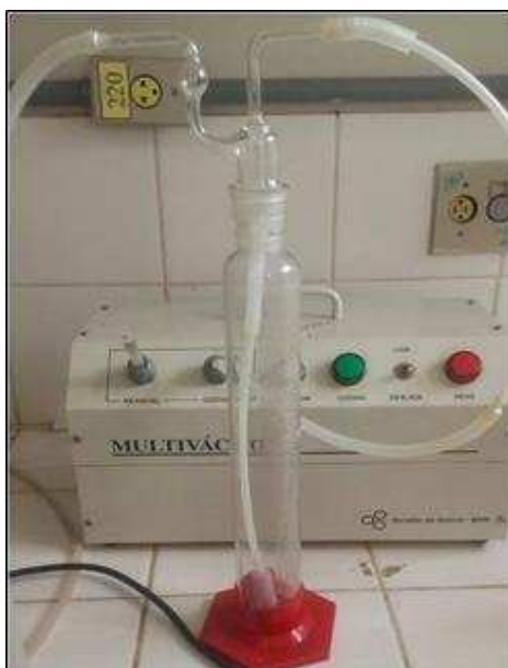
Figura 11. Frasco lavador de gases usado como compartimento para ozonização da água.
