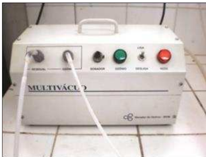
Figura 10. Gerador de ozônio utilizado no trabalho.
