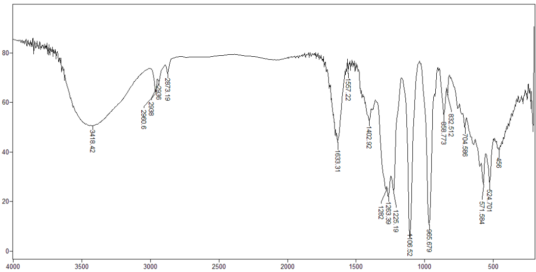
Espectro no infravermelho do ditiocarbimato 2c (pastilha de CsI).
